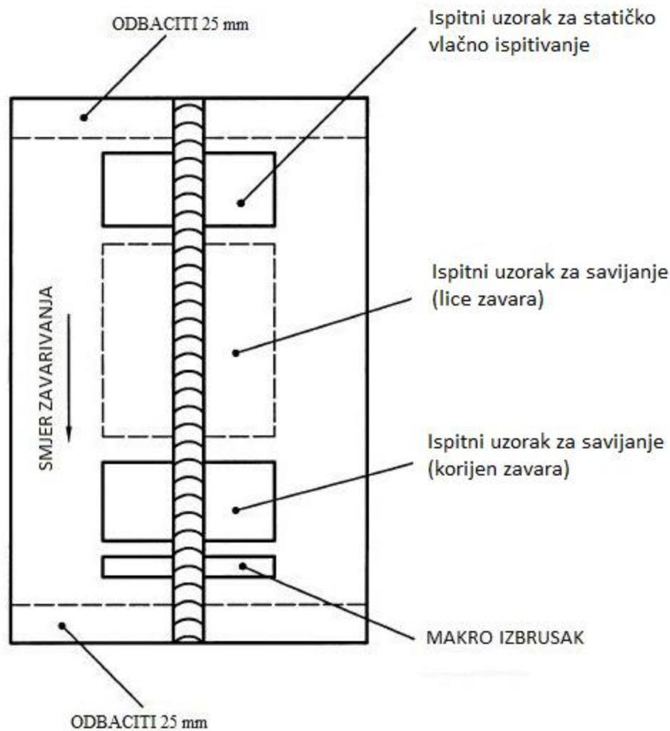
Slika 32. Mjesta za vađenje ispitnih uzoraka iz zavarenog spoja
