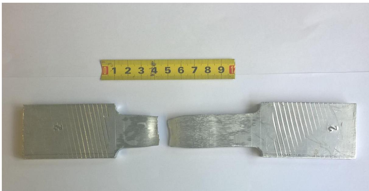
Slika 37. Uzorak B nakon statičkog vlačnog ispitivanja
