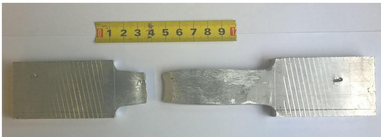
Slika 35. Uzorak A nakon statičkog vlačnog ispitivanja
