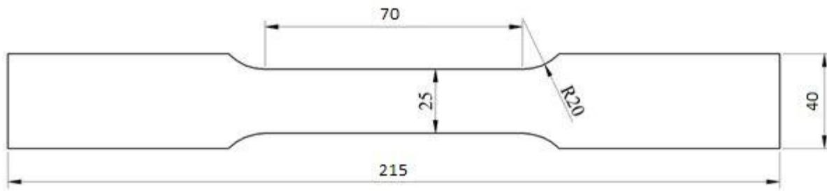
**Slika 33. Dimenzije epruvete za statičko vlačni pokus**
