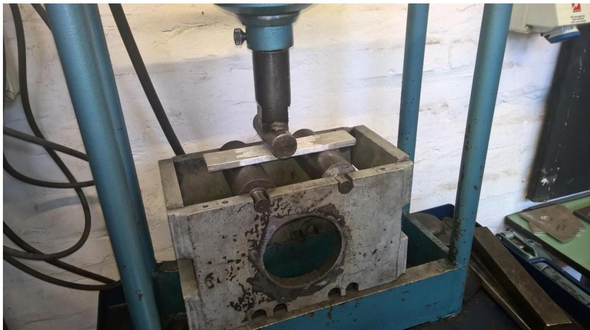
Slika 39. Ispitivanje savijanjem u Labaratoriju za zavarivanje FSB
