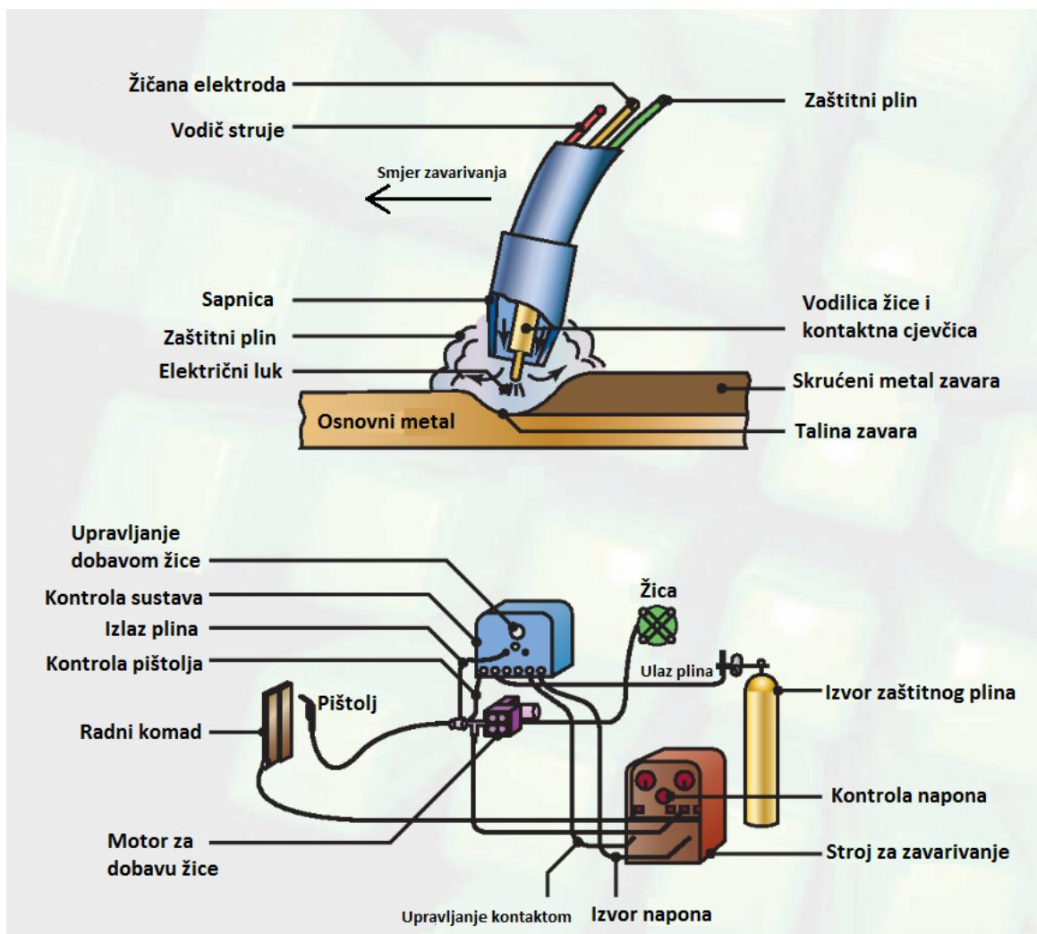
Slika 1. Shematski prikaz zavarivanja taljivom metalnom elektrodom [4]
