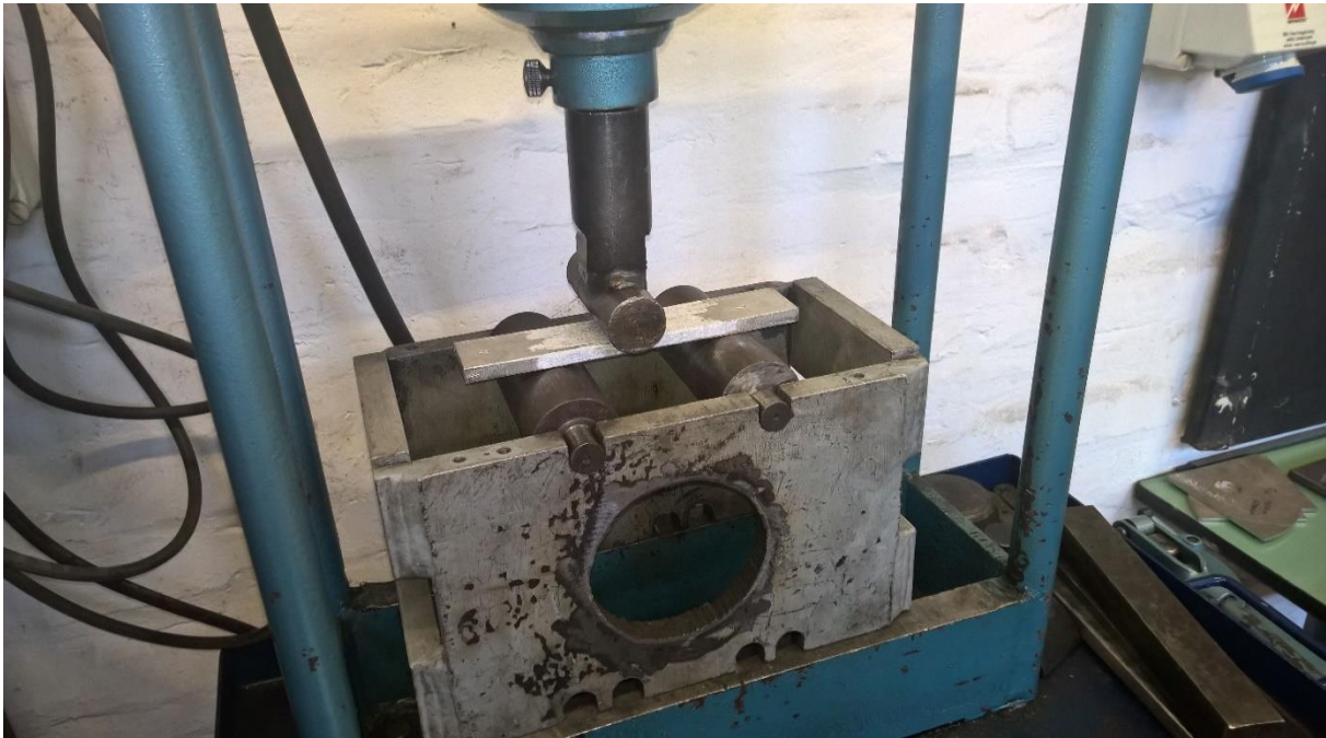
Slika 39. Ispitivanje savijanjem u Laboratoriju za zavarivanje FSB
