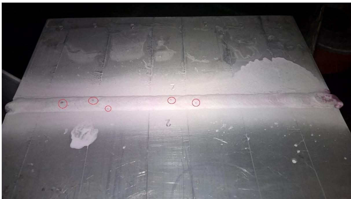
**Slika 30. Lice zavara uzorka B nakon ispitivanja penetrantima**
