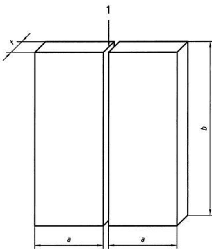
**Slika 19.** Uzorak za zavarivanje sučeljnog spoja sa potpunom penetracijom [31]
