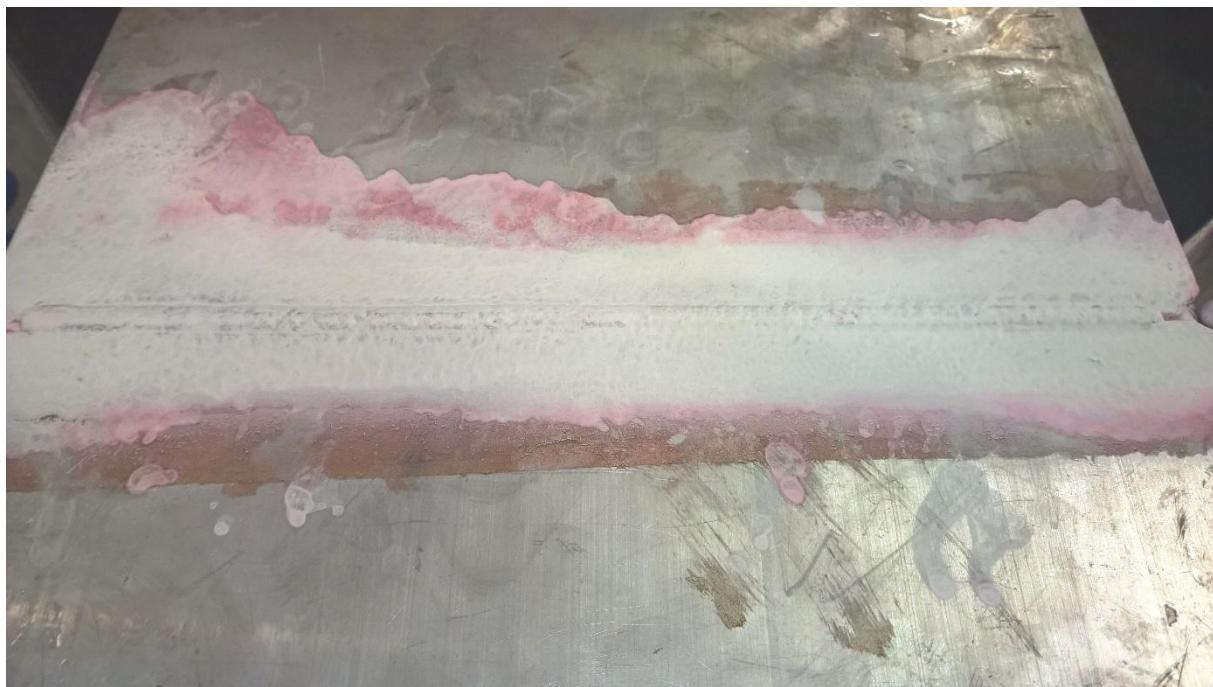
**Slika 29. Korijen zavara uzorka A nakon ispitivanja penetrantima**
