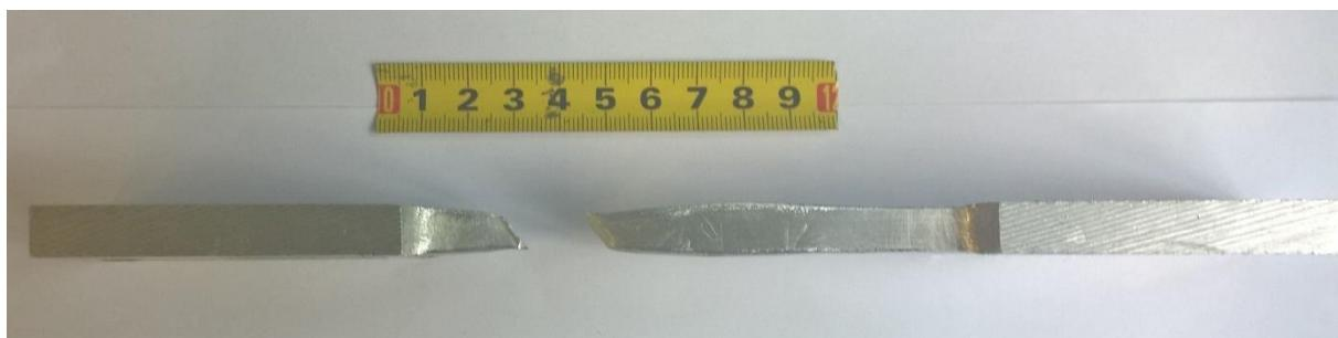
Slika 36. Uzorak A nakon statičkog vlačnog ispitivanja
