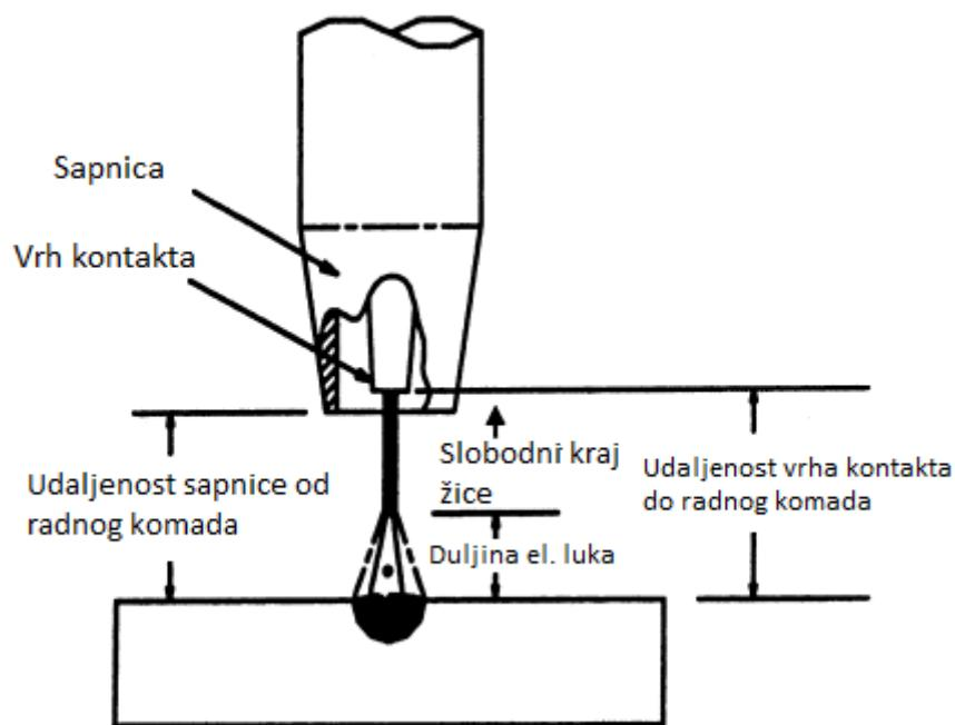
Slika 3. Shema zavarivanja kod MIG/MAG postupka [11]
