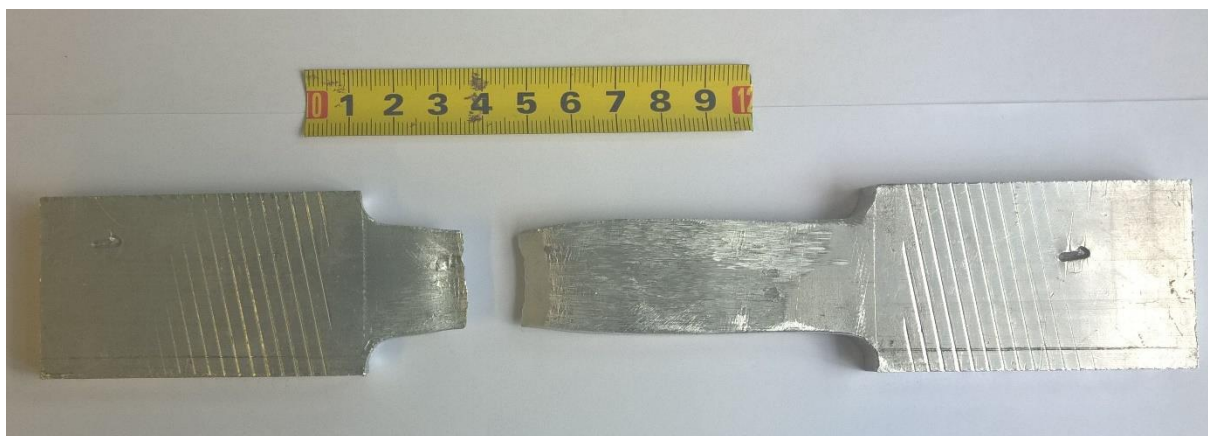
Slika 35. Uzorak A nakon statičkog vlačnog ispitivanja
