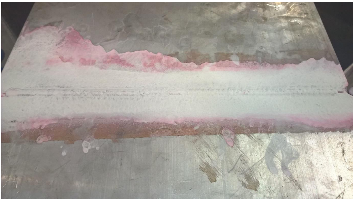
Slika 29. Korijen zavara uzorka A nakon ispitivanja penetrantima
