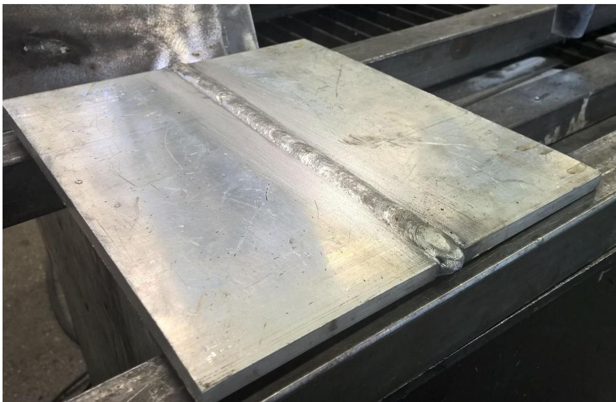
Slika 24. Lice zavara uzorka A
