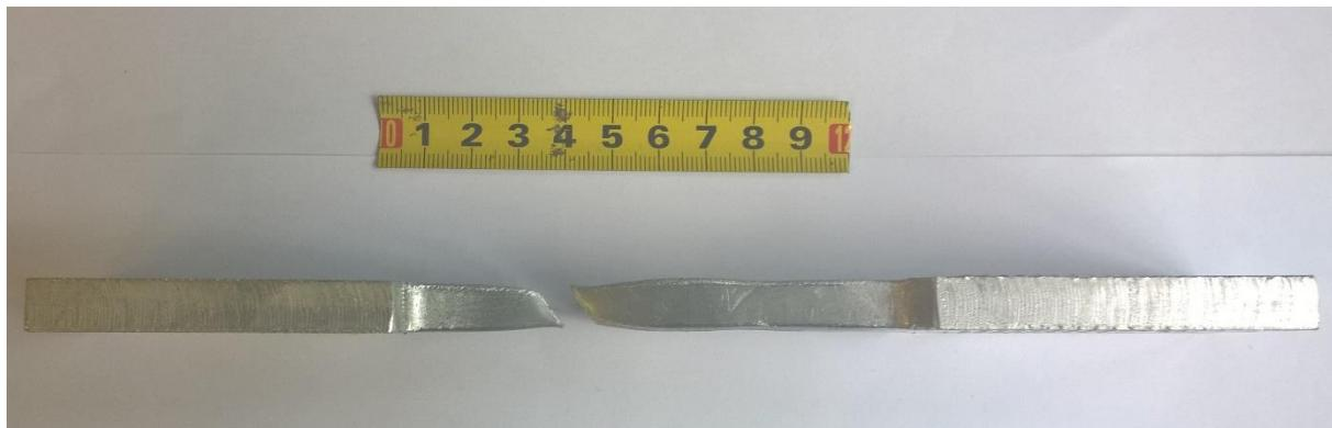
**Slika 38.** Uzorak B nakon statičkog vlačnog ispitivanja
