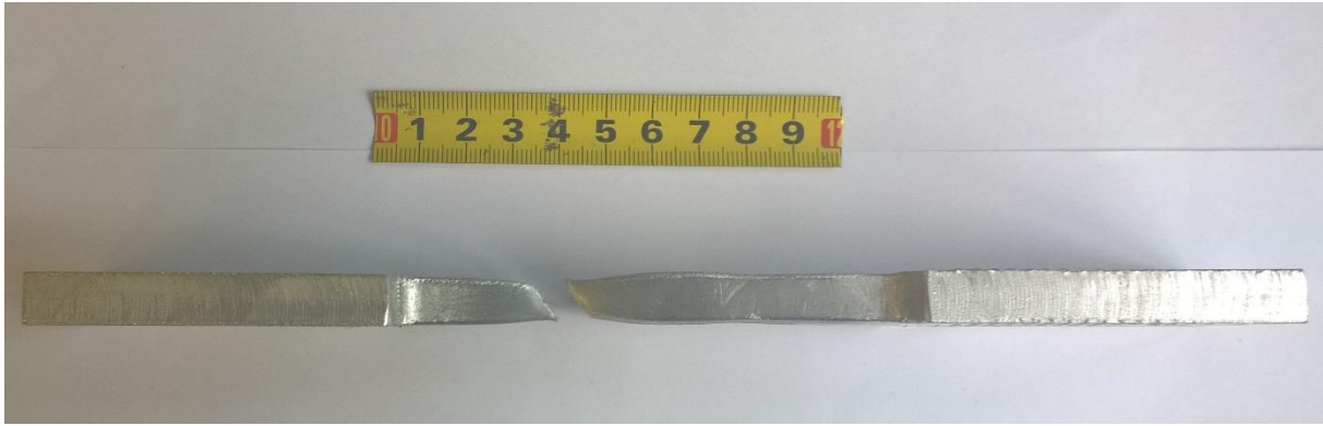
Slika 38. Uzorak B nakon statičkog vlačnog ispitivanja
