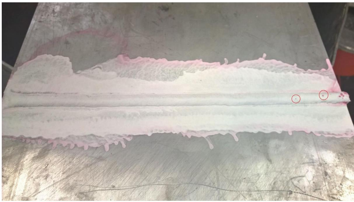
**Slika 31. Korijen zavara uzorka B nakon ispitivanja penetrantima**
