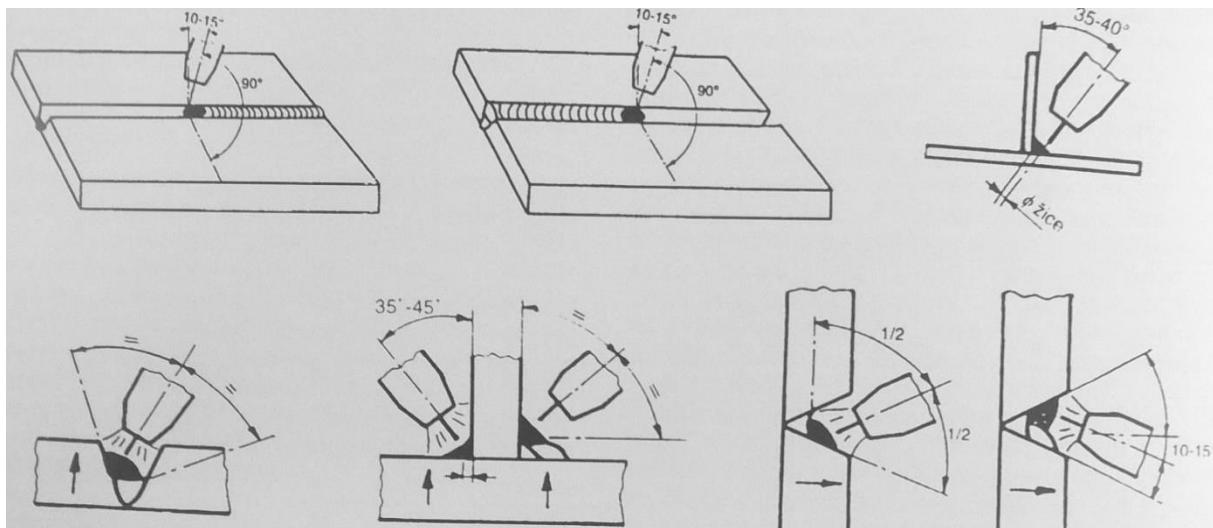
Slika 14. Primjeri nagiba pištolja kod MIG poluautomatskog zavarivanja [20]
