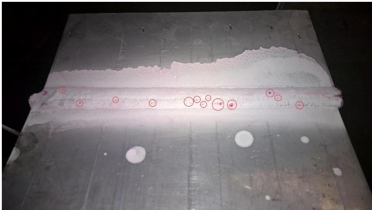
**Slika 28. Lice zavara uzorka A nakon ispitivanja penetrantima**
