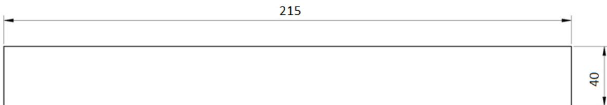
Slika 40. Dimenzije upravete za savijanje
