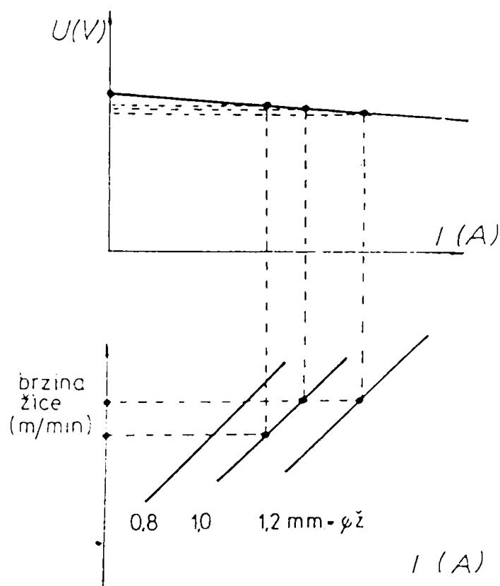
Slika 2. Odnos vanjske karakteristike izvora struje i brzine žice [6]
