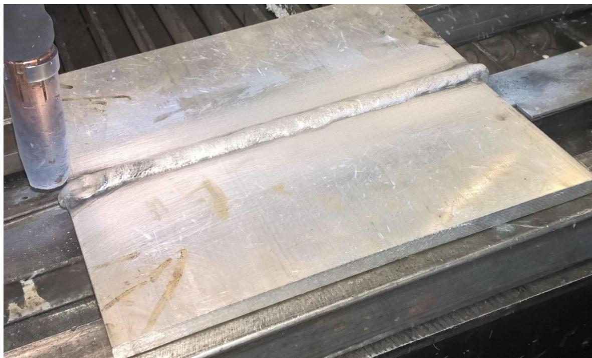
Slika 26. Lice zavara uzorka B
