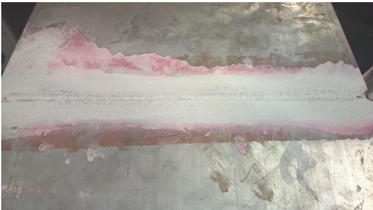
Slika 29. Korijen zavara uzorka A nakon ispitivanja penetrantima
