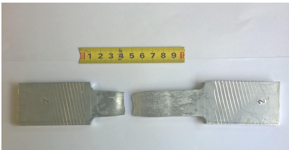
Slika 37. Uzorak B nakon statičkog vlačnog ispitivanja
