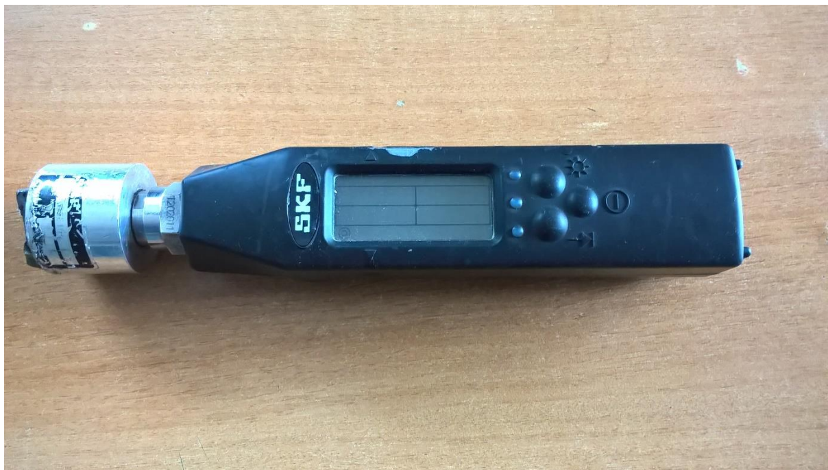
Slika 40. SKF uređaj za mjerenje vibracija
