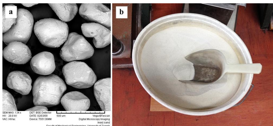
Slika 26. Čestice kvarcnog pijeska prikazane na: (a) SEM snimci [10]; (b) u posudi
