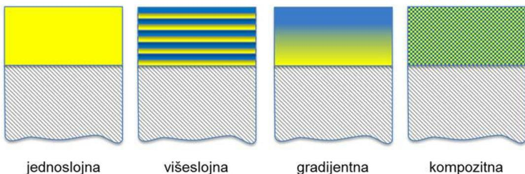
Slika 10. Vrste struktura tvrdih prevlaka [9]
