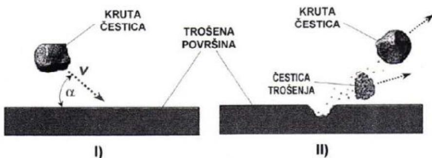
**Slika 16. Jedinični sudar krute čestice s trošenom površinom [14]**
