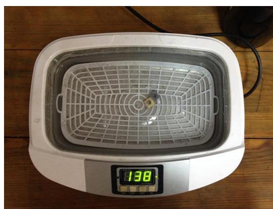
Slika 23. Čišćenje uzorka u ultrazvučnoj kupki
