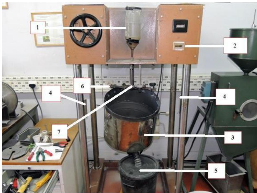
Slika 25. Uređaj za ispitivanje otpornosti na eroziju [15]
