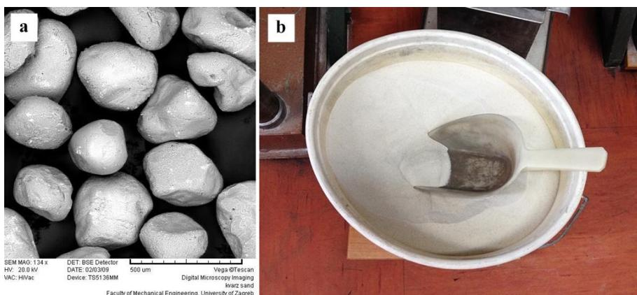
**Slika 26. Čestice kvarcnog pjeska prikazane na: (a) SEM snimci [10]; (b) u posudi**
