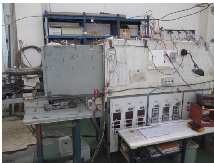
Slika 21. Peć za sinteriranje u atmosferi vodika proizvođača Alfa tim d.o.o., Hrvatska [1]
