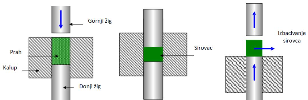
**Slika 4. Postupak jednoosnog kompaktiranja u kalupu [1]**
