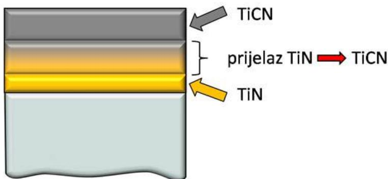
Slika 12. Shematski prikaz strukture gradijentne TiCN prevlake [9]
