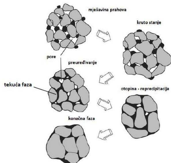
Slika 5. Faze zgušnjavanja tijekom sinteriranja u tekućoj fazi [1]
