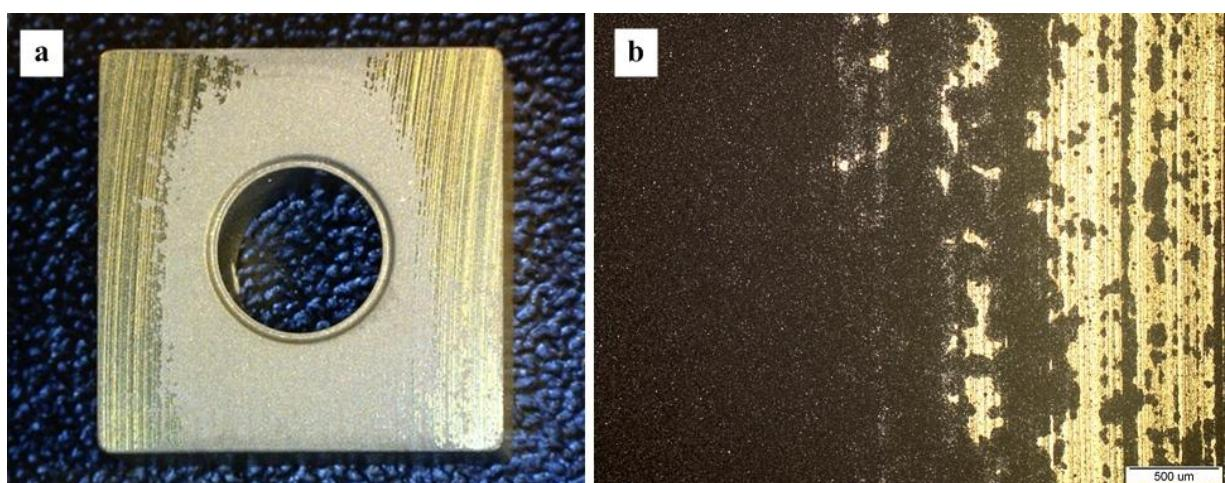
**Slika 34. Površina uzorka 2 nakon trošenja pri kutu upada erodenta od  $60^\circ$  dobivena:**
