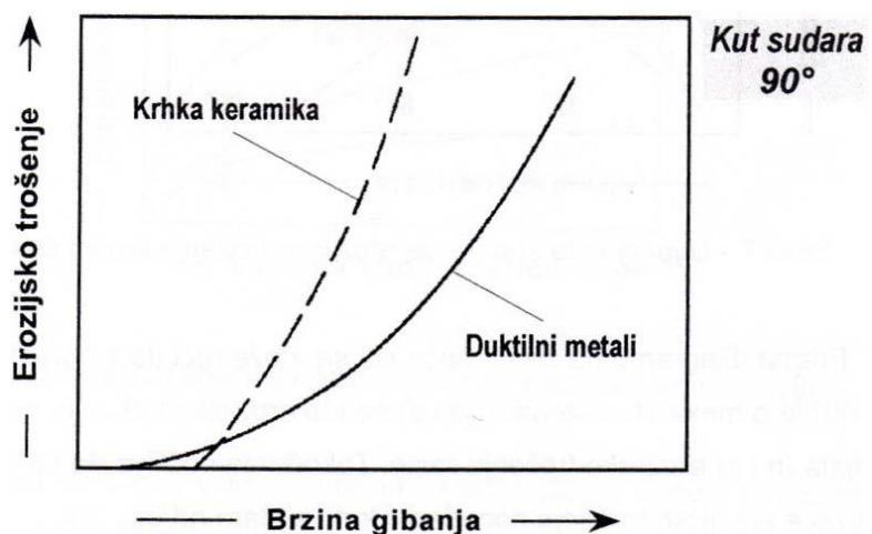
Slika 19. Utjecaj brzine gibanja na erozijsko trošenje krutim česticama pri kutu udara od  $90^\circ$  [10]
