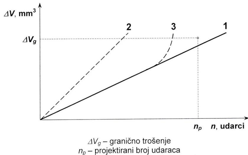
**Slika 15. Procesi trošenja erozijom česticama [16]**
