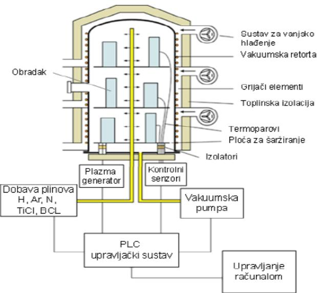
**Slika 13. Shematski prikaz PACVD uređaja [9]**
