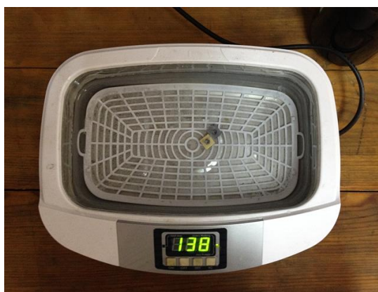
Slika 23. Čišćenje uzoraka u ultrazvučnoj kupki
