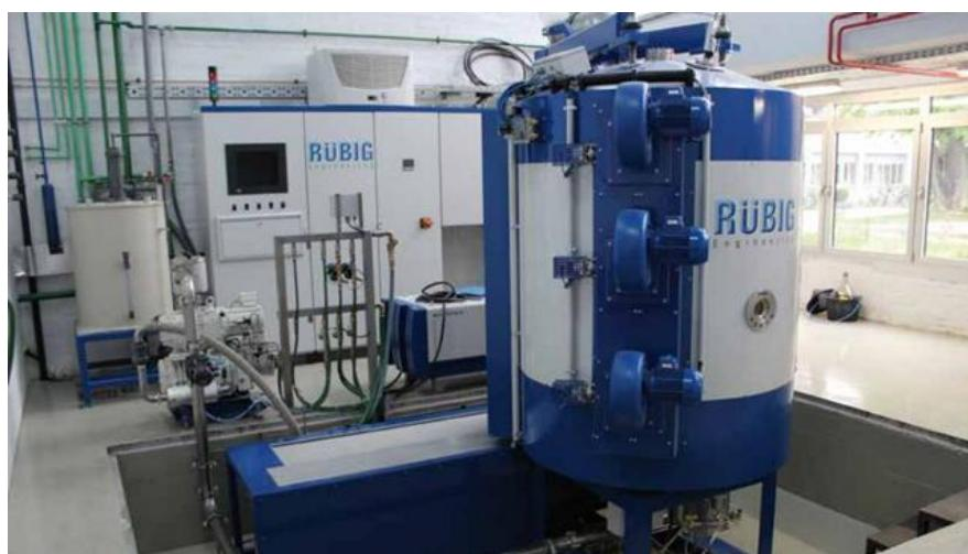
Slika 22. PACVD uređaj tvrtke Rübig instaliran na Fakultetu strojarstva i brodogradnje [10]
