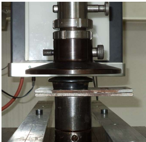
Slika 6.2. Eksperimentalne postavke za tlačno ispitivanje
