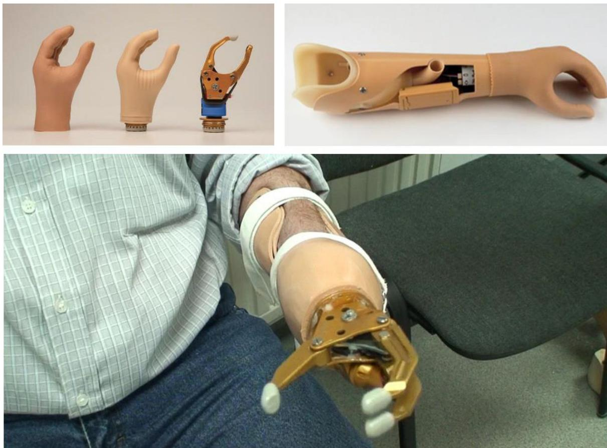
Slika 3.6. Mioelektrična proteza za bataljak podlaktice [9]
