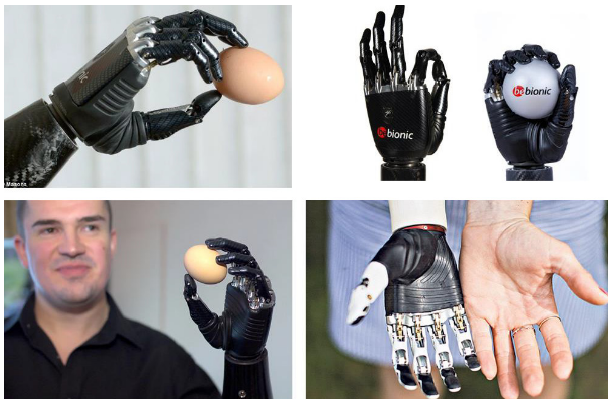
Slika 3.7. Proteza za podlakticu BeBionic [11]
