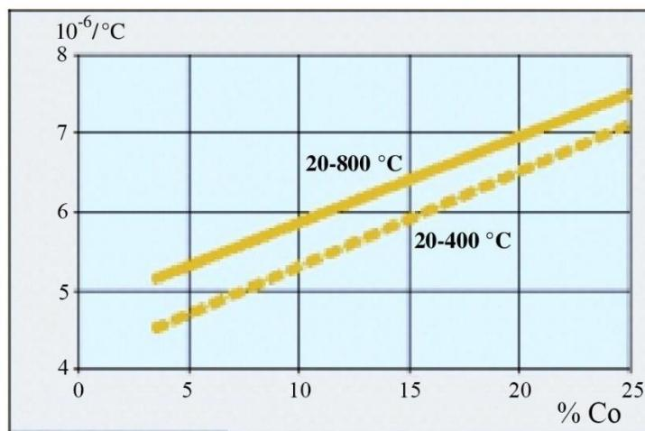
Slika 11. Ovisnost koeficijenta linearног toplinskog rastezanja o udjelu materijala matrice [9]
