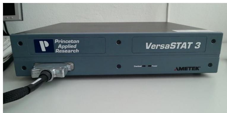
Slika 31. Potenciostat/galvanostat VersaSTAT 3
