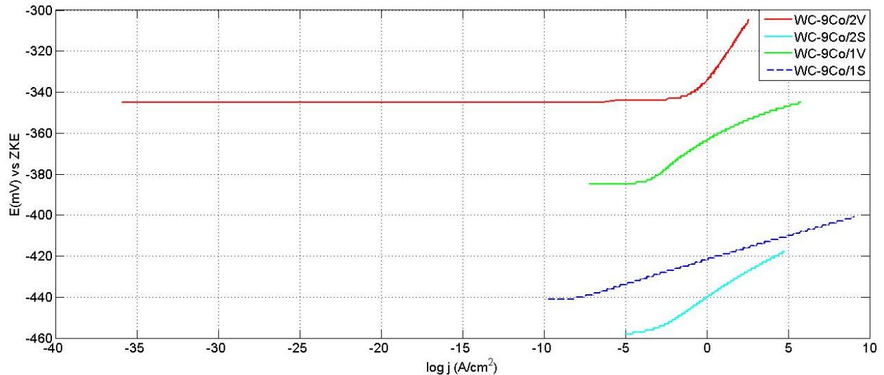
Slika 27. Dijagram polarizacijskih krivulja uzoraka na malom intervalu  $\log I$  i većim vrijednostima  $E_{corr}$
