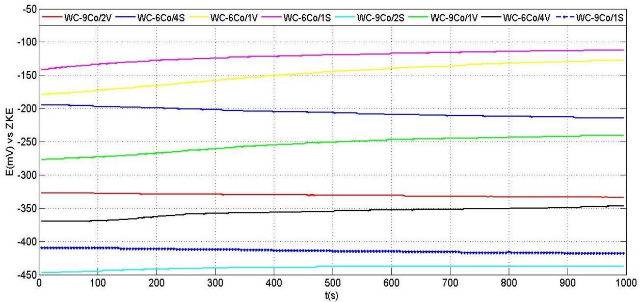
**Slika 26. Dijagrami koroziskog potencijala ovisno o vremenu**
