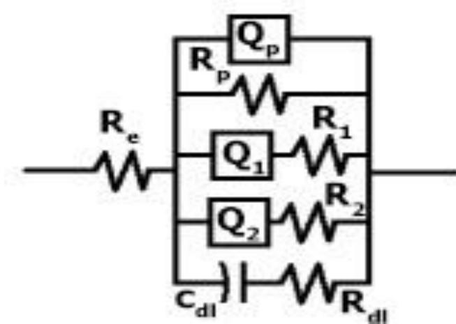
**Slika 40. Odabrani model ekvivalentnog električnog kruga uzorka**
