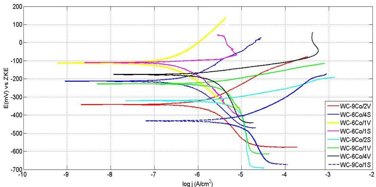
Slika 29. Tafelovi dijagrami uzoraka dobiveni elektrokemijskim mjeranjem
