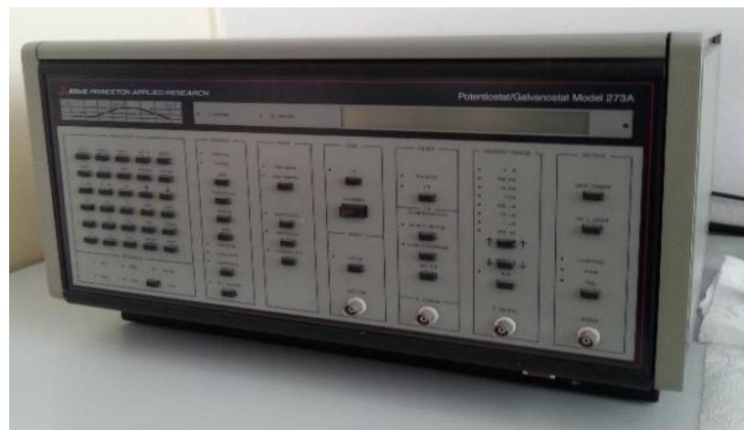
Slika 23. Potenciostat/Galvanostat Model 273A EG&E
