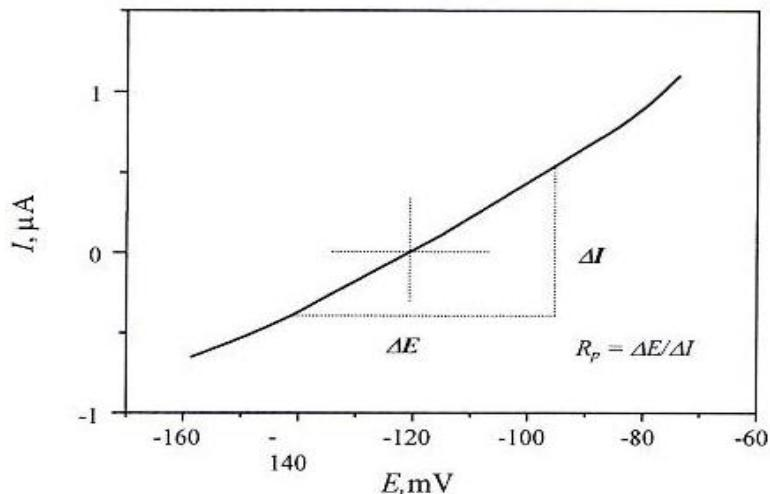
Slika 16. Određivanje polarizacijskog otpora  $R_p$  prema Mansfeldu [21]
