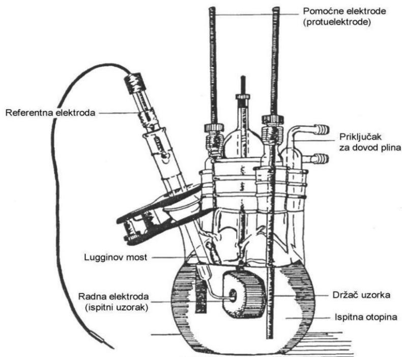
Slika 14. Ispitna čelija za elektrokemijsko ispitivanje [20]
