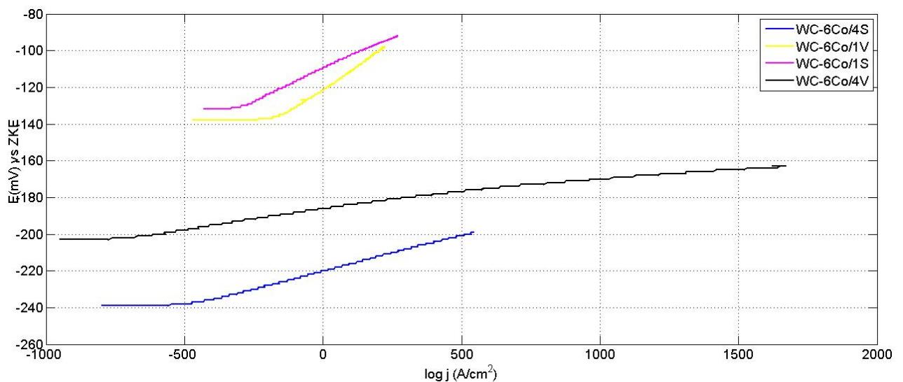
Slika 28. Dijagram polarizacijskih krivulja uzoraka na velikom intervalu log I i manjim vrijednostima  $E_{corr}$
