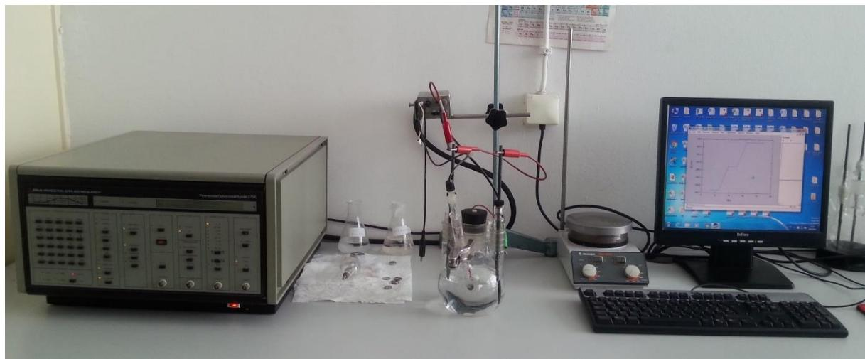
Slika 22. Ispitna oprema za elektrokemijska DC ispitivanja
