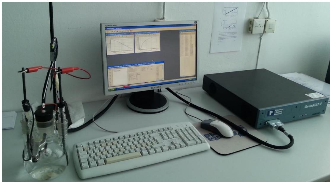
Slika 30. Ispitna oprema za elektrokemijska AC ispitivanja
