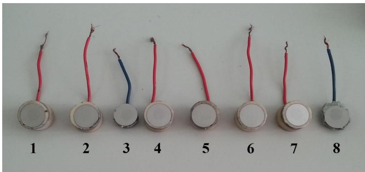
Slika 21. Ispitni uzorci od WC-Co tvrdog metala
