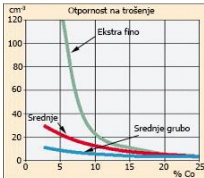
Slika 9. Otpornost na trošenje u funkciji udjela Co i veličine WC zrna [9]
