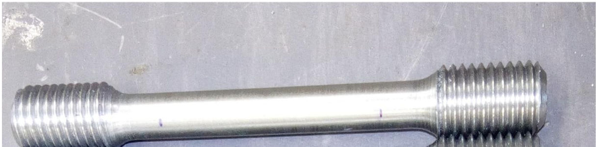
Slika 17. Označavanje ispitnog uzorka
