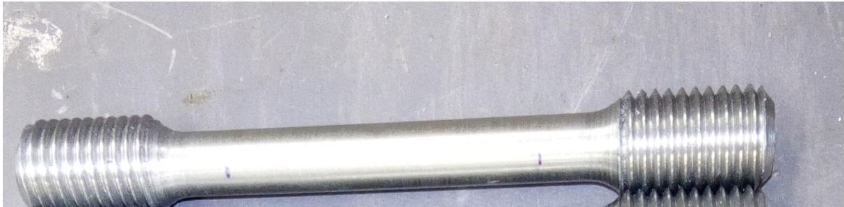
Slika 17. Označavanje ispitnog uzorka
