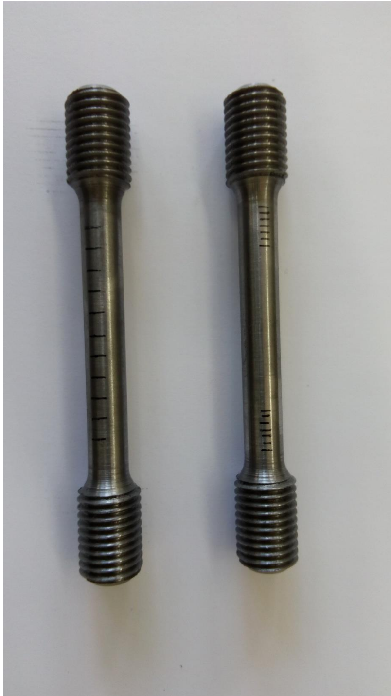
Slika 24. Označavanje duljine ispitivanja
