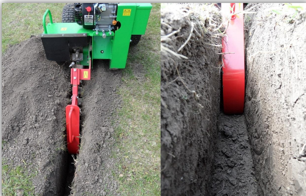
Slika 2. Primjer korištenja kanalokopača u poljoprivrednoj djelatnosti (priprema tla za sadnju biljnih kultura)
