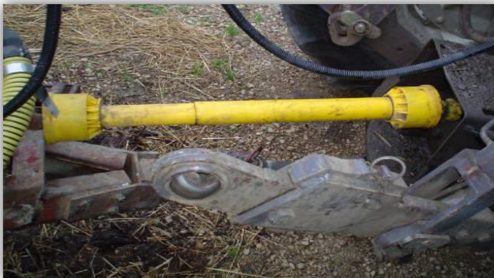
Slika 5. Priključak preko kardanskog vratila
