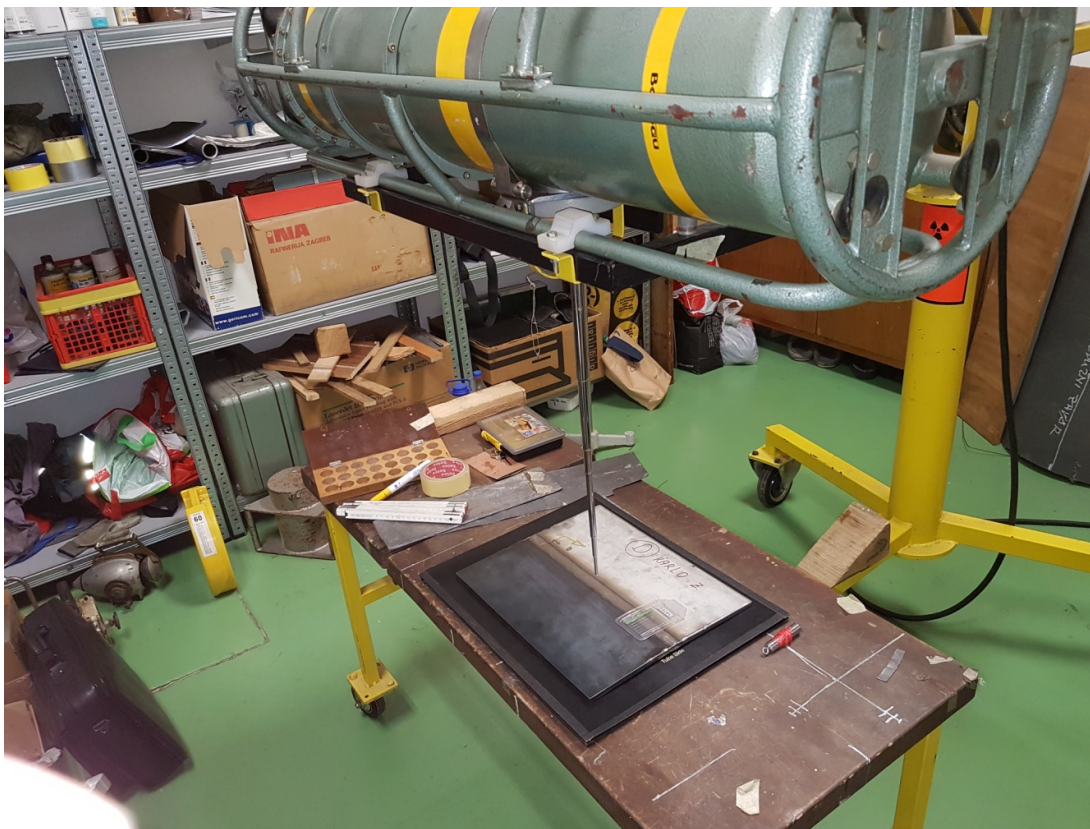
Slika 25. Uzorak pripremljen za rendgensko snimanje X zrakama
