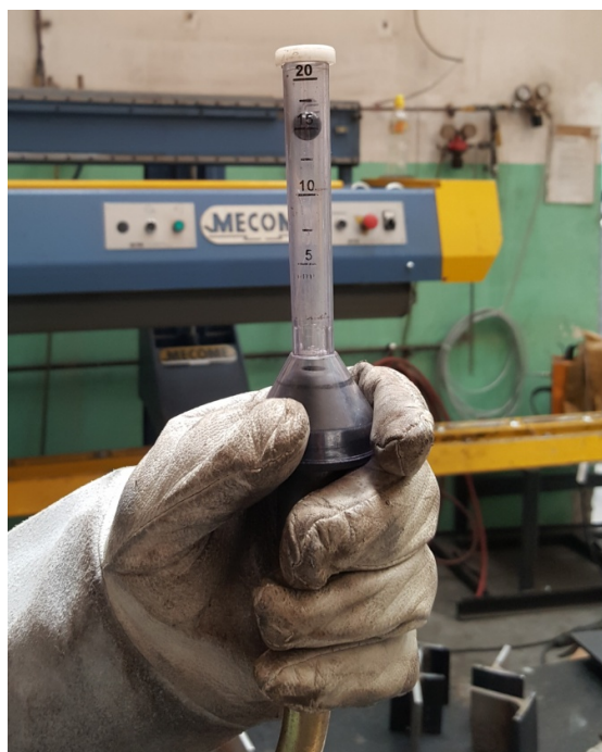
Slika 18. Provjera protoka plina
