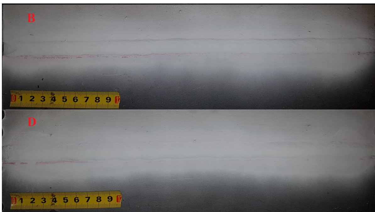
Slika 24. Uzorci sučelnog spoja nakon ispitivanja penetrantima, gornji - B, donji - D
