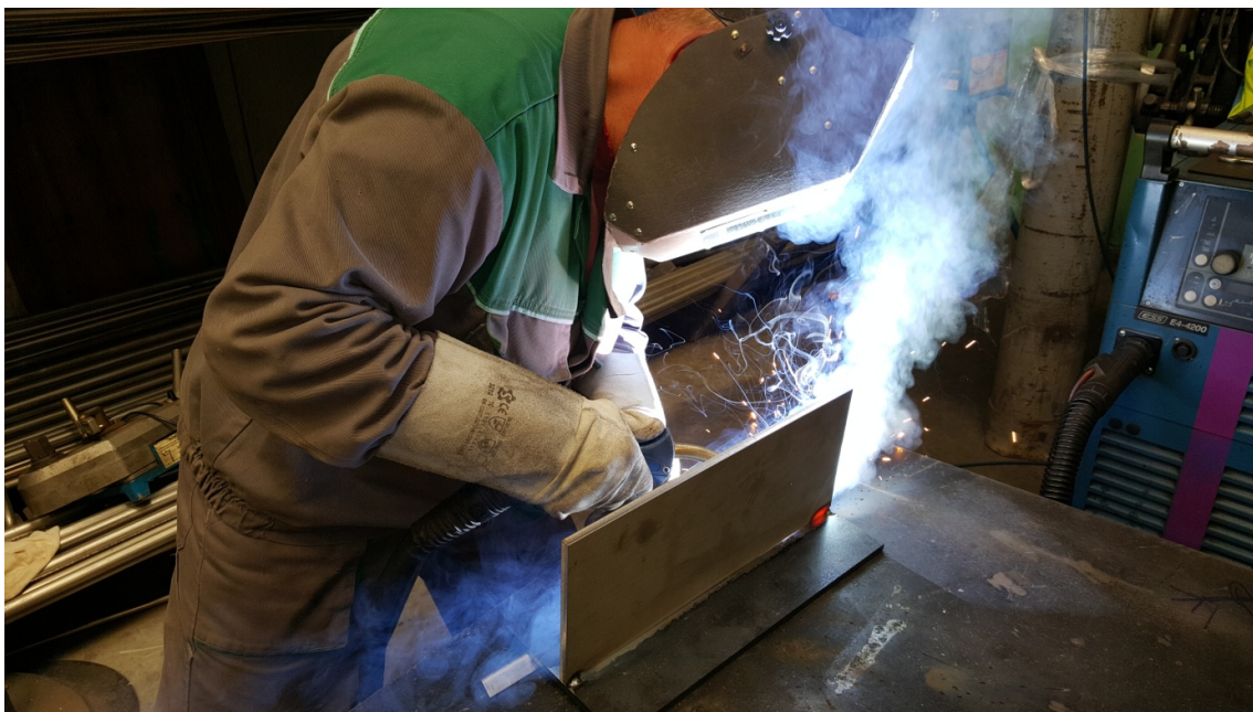
Slika 21. Zavarivanje uzorka kutnog spoja
