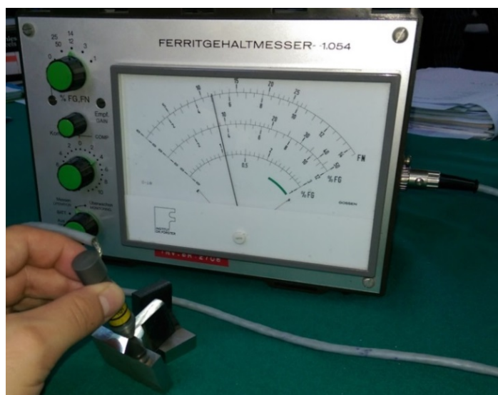
Slika 35. Uređaj za mjerenje feritnog broja
