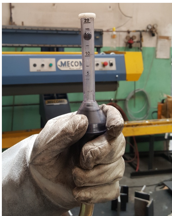
Slika 18. Provjera protoka plina
