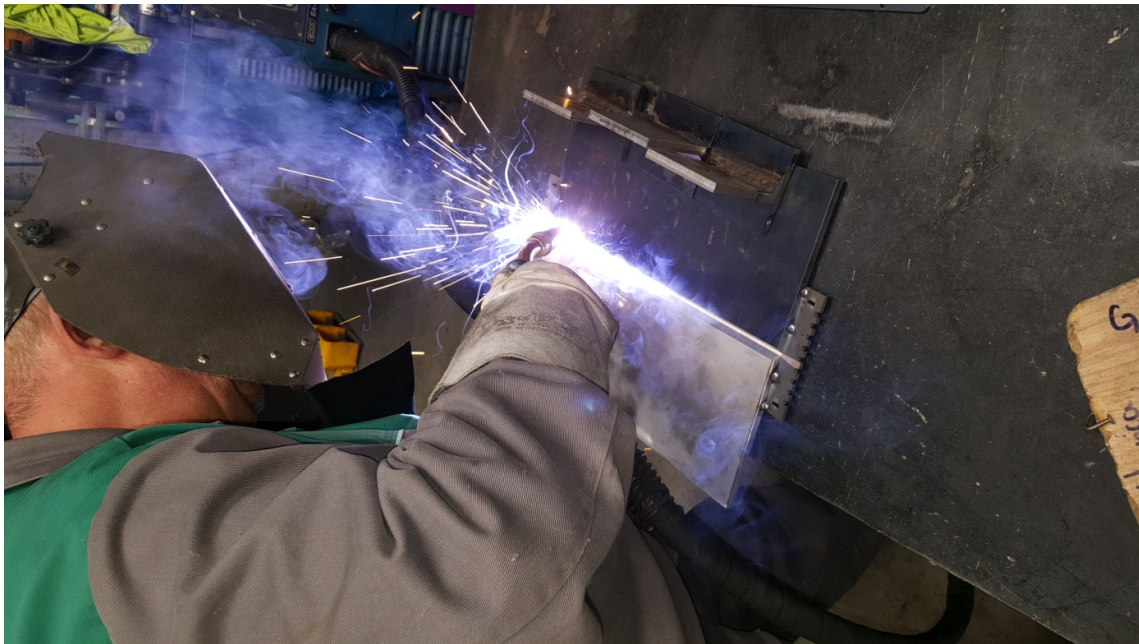
Slika 22. Zavarivanje korijena zavora sučeljenog spoja
