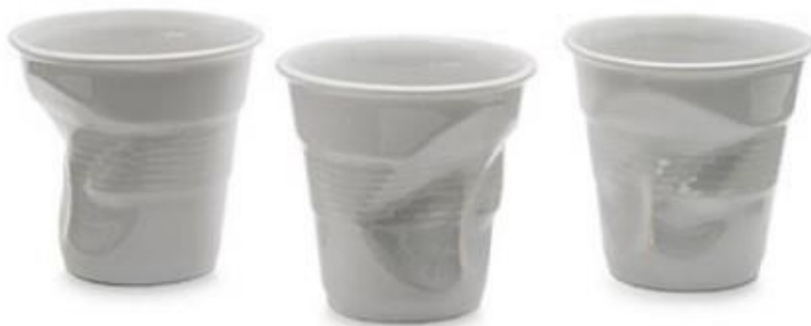
Slika 47. Izgužvane plastične čaše uslijed prevelikog pritiska prstiju [50]
