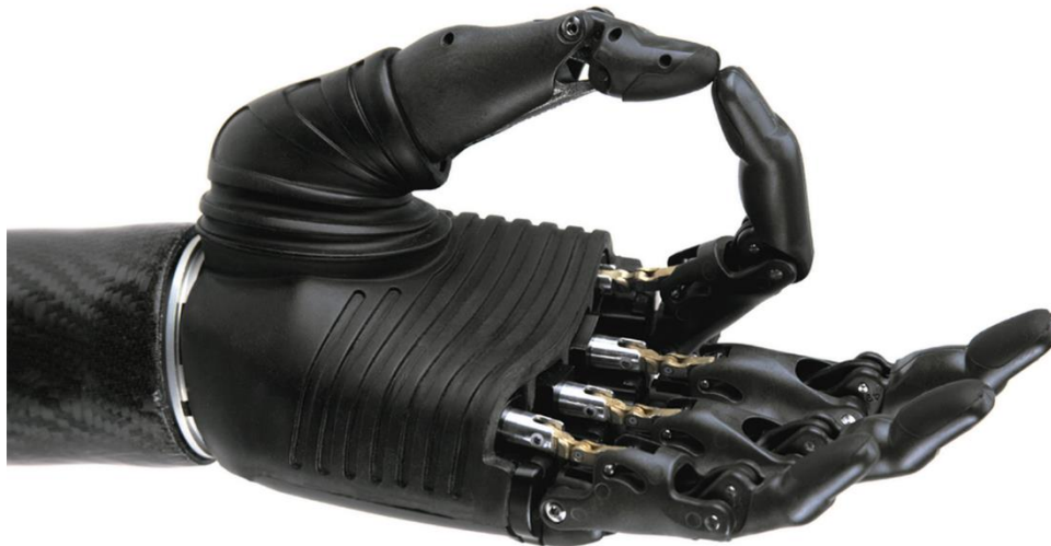
Slika 24. Mogućnost abdukcije palca i fleksije pojedinih prstiju proteze šake [23]
