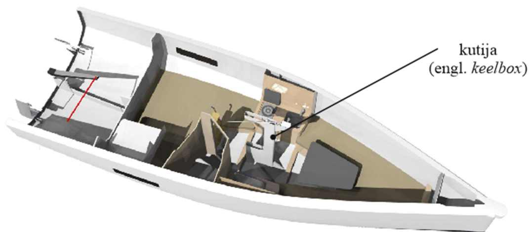
Slika 3. Presjek jedrilice s kutijom za uvlačivu kobilicu
