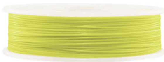
Slika 4.2. Polimerna žica – PA6
