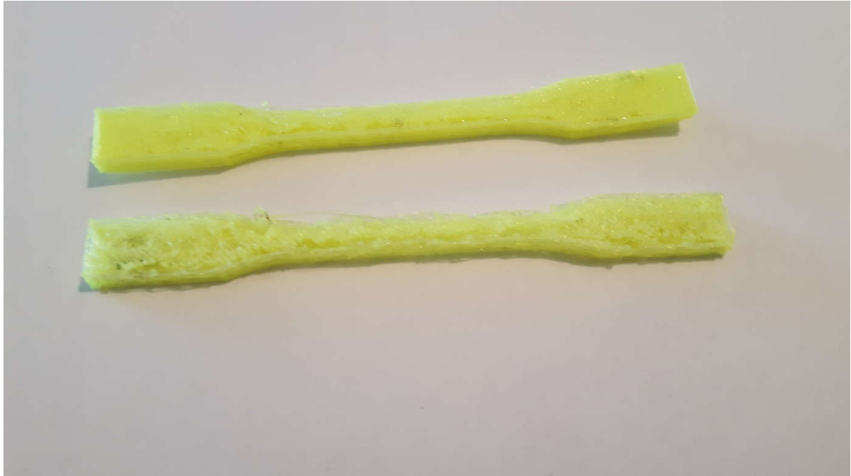
Slika 4.6. Prikaz raslojavanja slojeva i stvaranje mjehurića na površini
