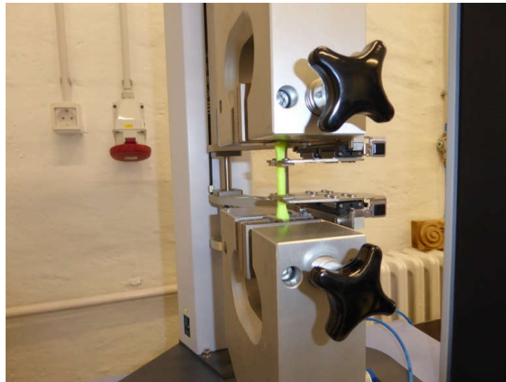
Slika 4.15. Čeljusti za ispitivanje rastezних svojstava
