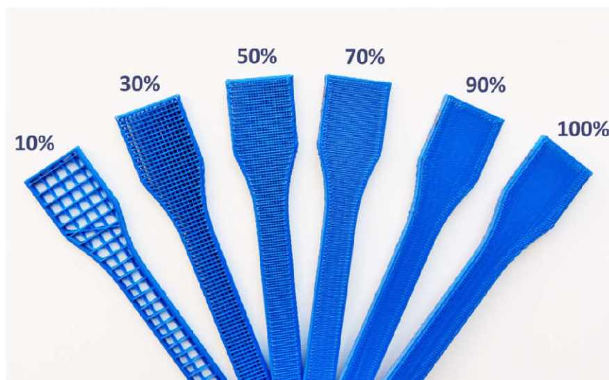
Slika 3.4. Prikaz različitih vrijednosti postotka ispune modela [11]
