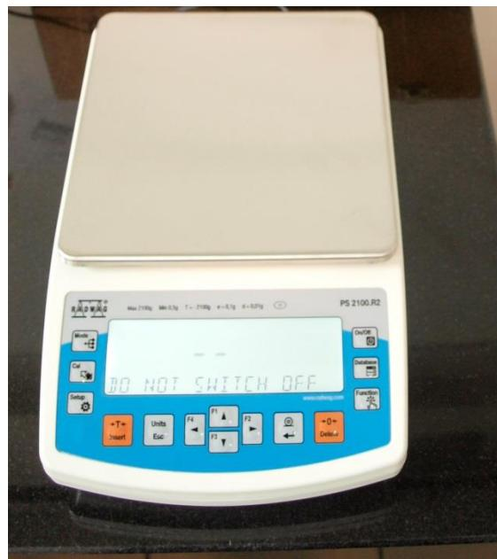
**Slika 10.** Vaga proizvođača RADWAG tipa PS 2100. R2
