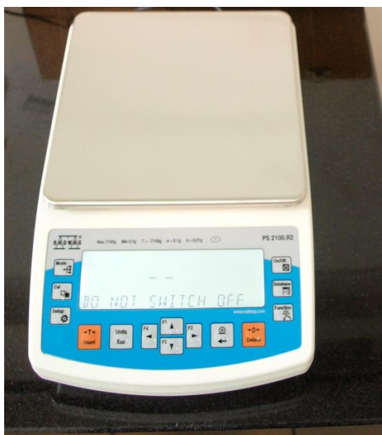
Slika 10. Vaga proizvođača RADWAG tipa PS 2100. R2
