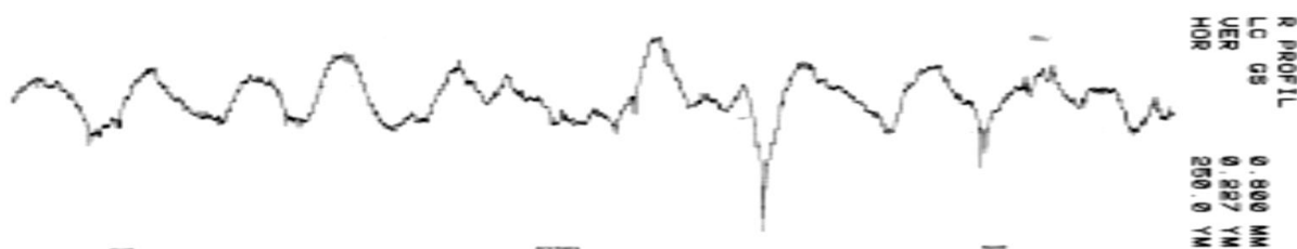
Slika 58. Profil hrapavosti osnovnog materijala, uzorak 1
