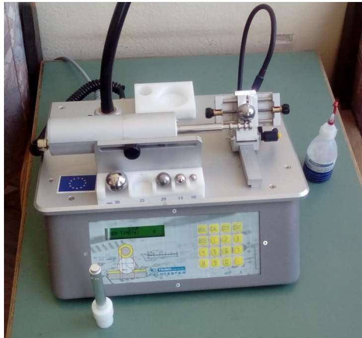
Slika 41. Uređaj za mjerenje debljine prevlake (kalotest)
