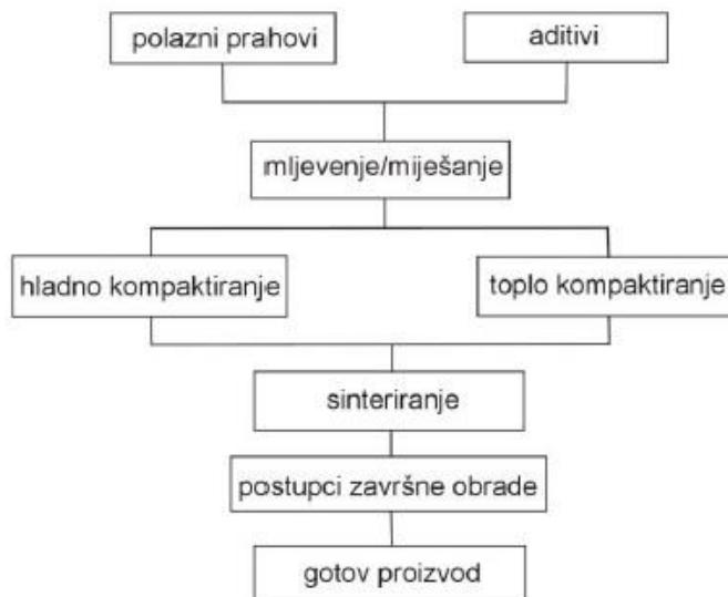
Slika 5. Hodogram tehnoloških operacija konvencionalnog postupka metalurgije praha[6]
