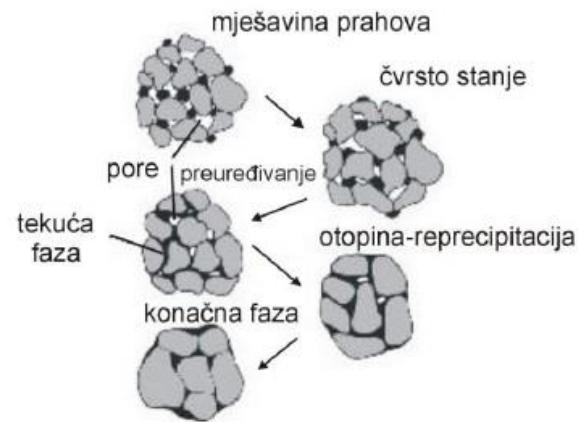
Slika 13. Faze zgušnjavanja tijekom sinteriranja u rastaljenoj fazi [6]
