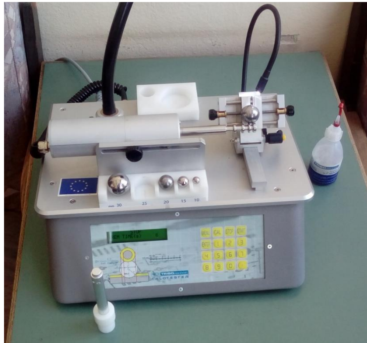
Slika 41. Uređaj za mjerenje debljine prevlake (kalotest)
