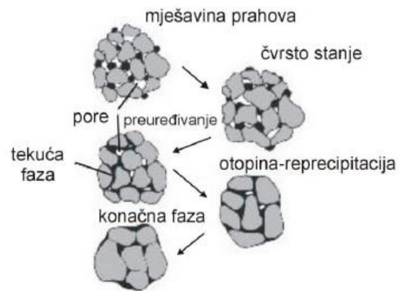
Slika 13. Faze zgušnjavanja tijekom sinteriranja u rastaljenoj fazi [6]
