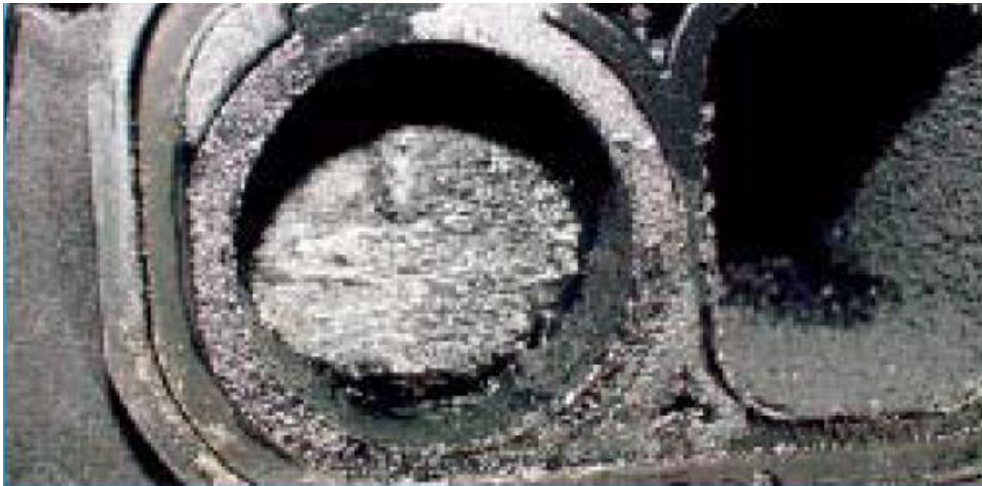
Slika 26. Otkaz leptira u usisnoj grani zbog debelih naslaga [6]
