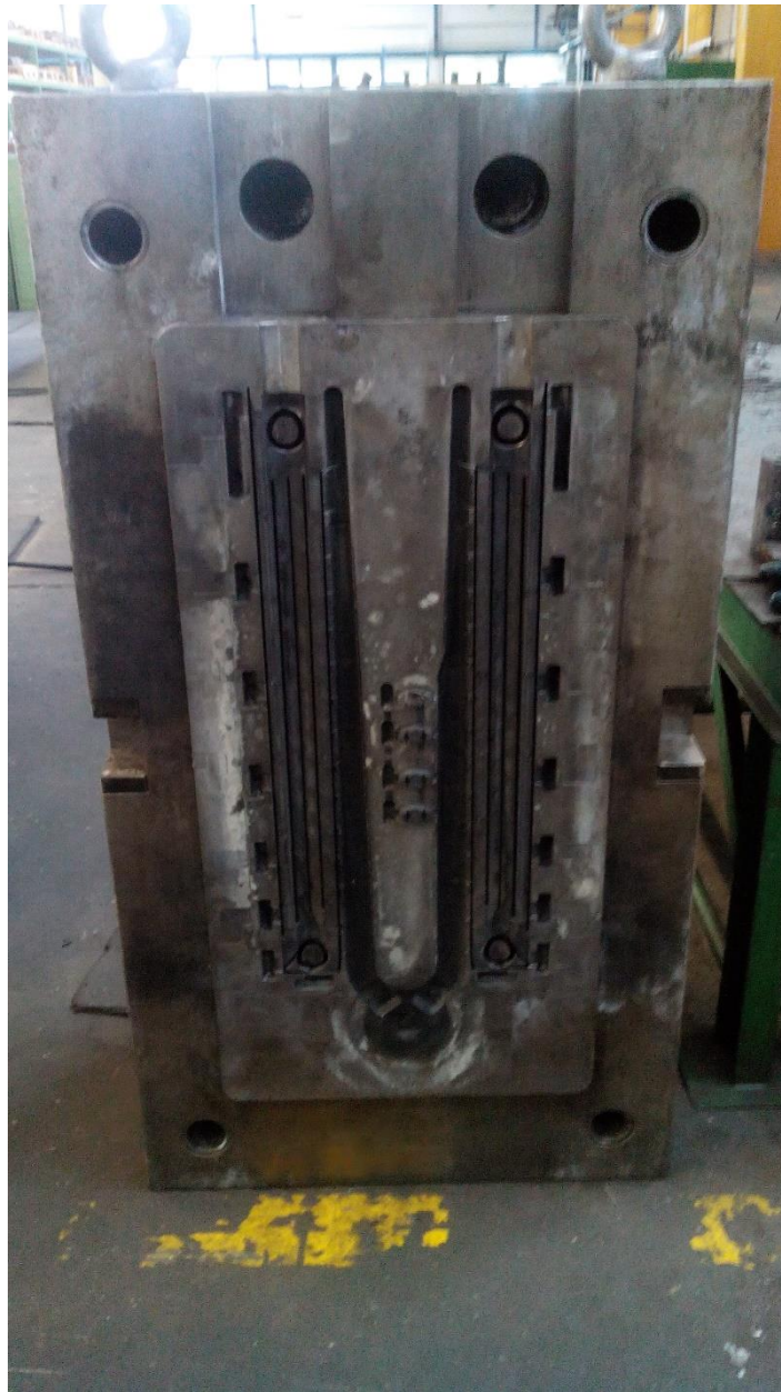
Slika 17. Polovica kalupa za lijevanje
