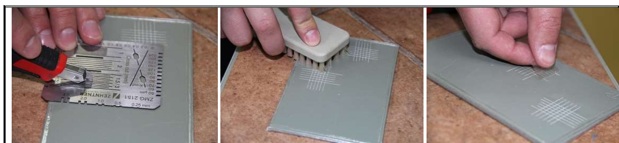
Slika 50. Postupak ispitivanja prionjivosti premaza [10]
