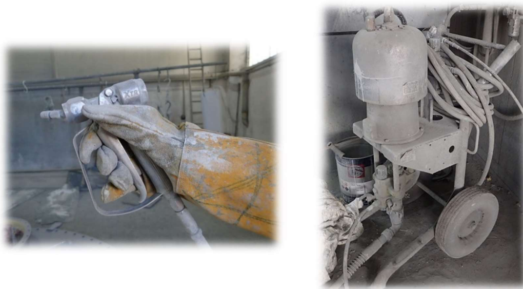
Slika 27. Nanošenje premaza bezračnim postupkom [1]
