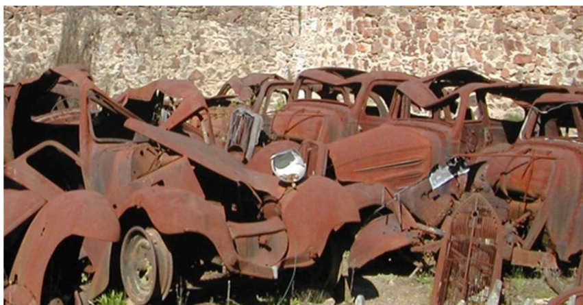
Slika 2. Primjer kemijskog oštećivanja atmosferskom korozijom [5]
