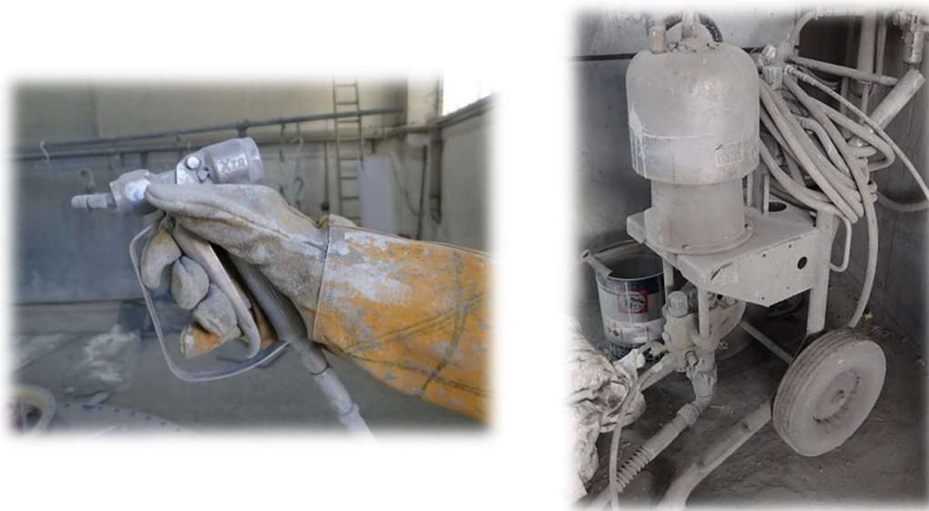
Slika 27. Nanošenje premaza bezračnim postupkom [1]
