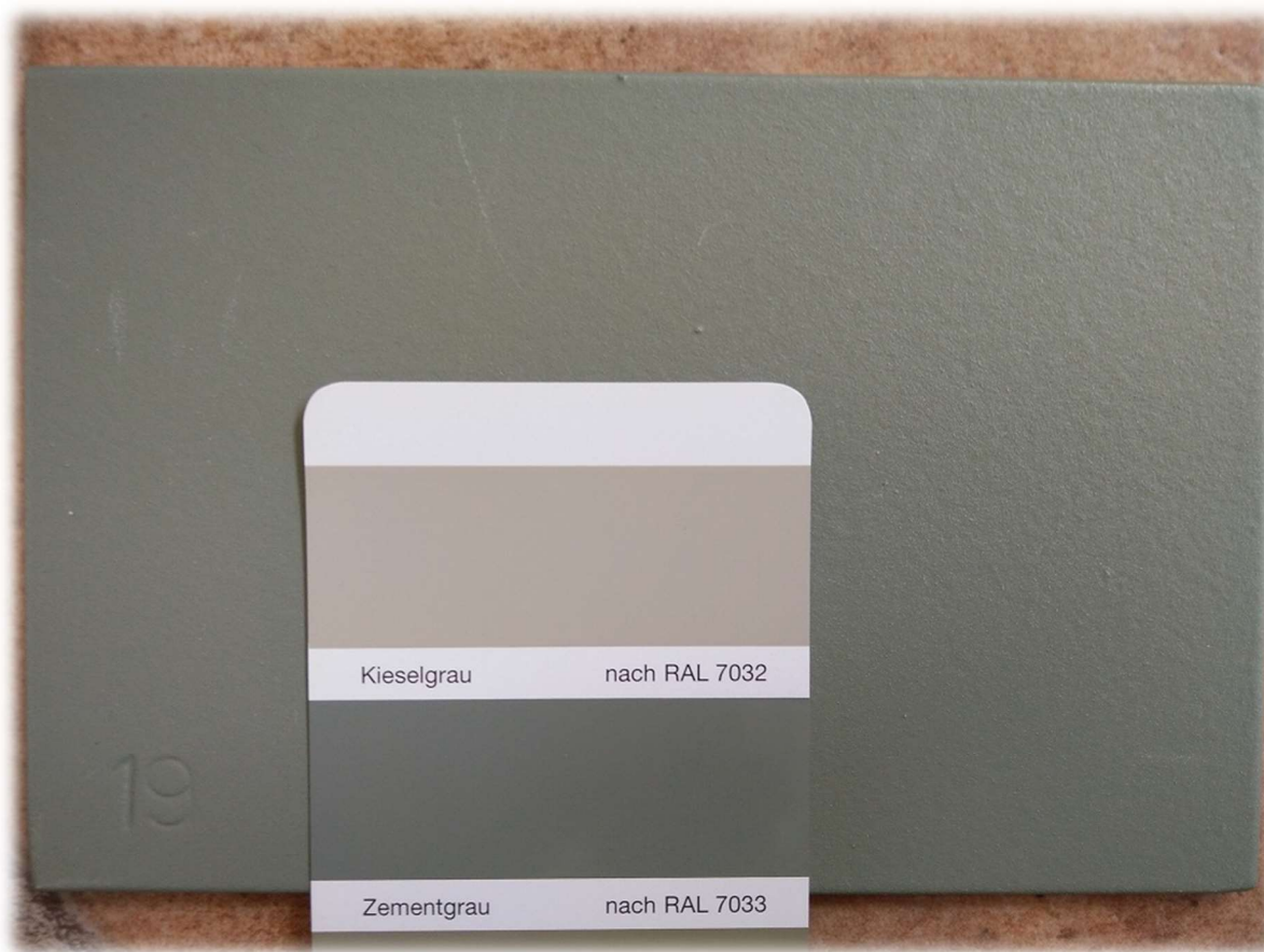
Slika 39. Određivanje nijanse premaza prema RAL-u [10]
