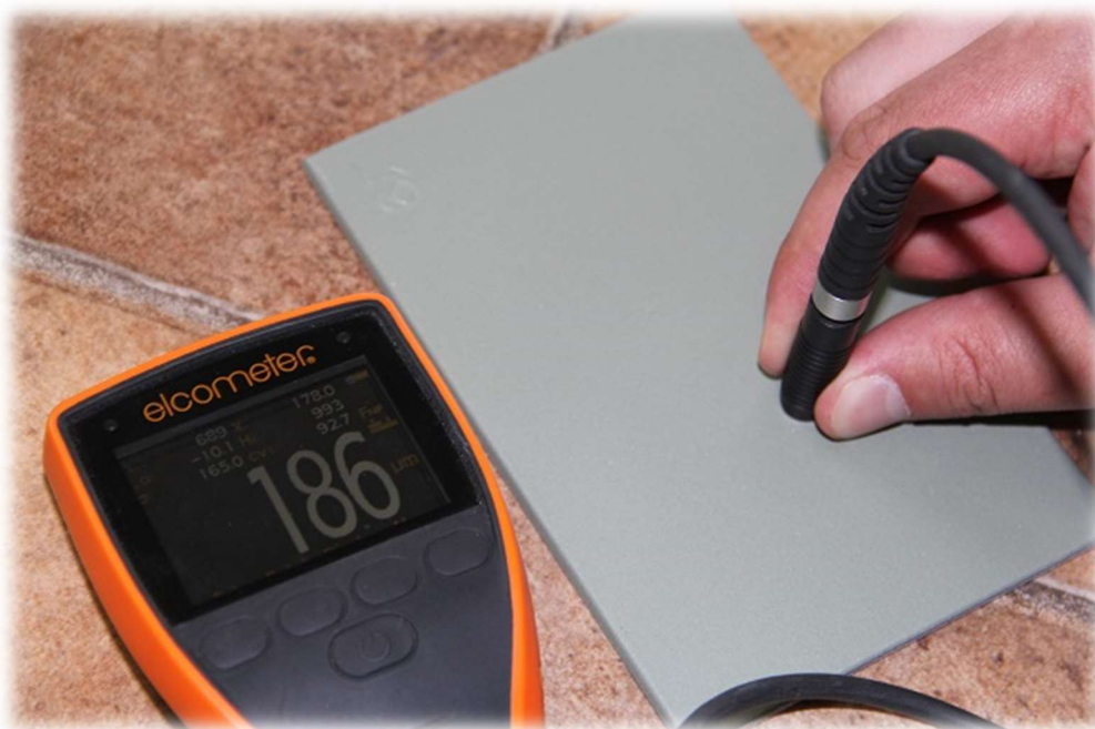
Slika 37. Uređaj Elcometer 456 za mjerenje debljine prevlake [10]
