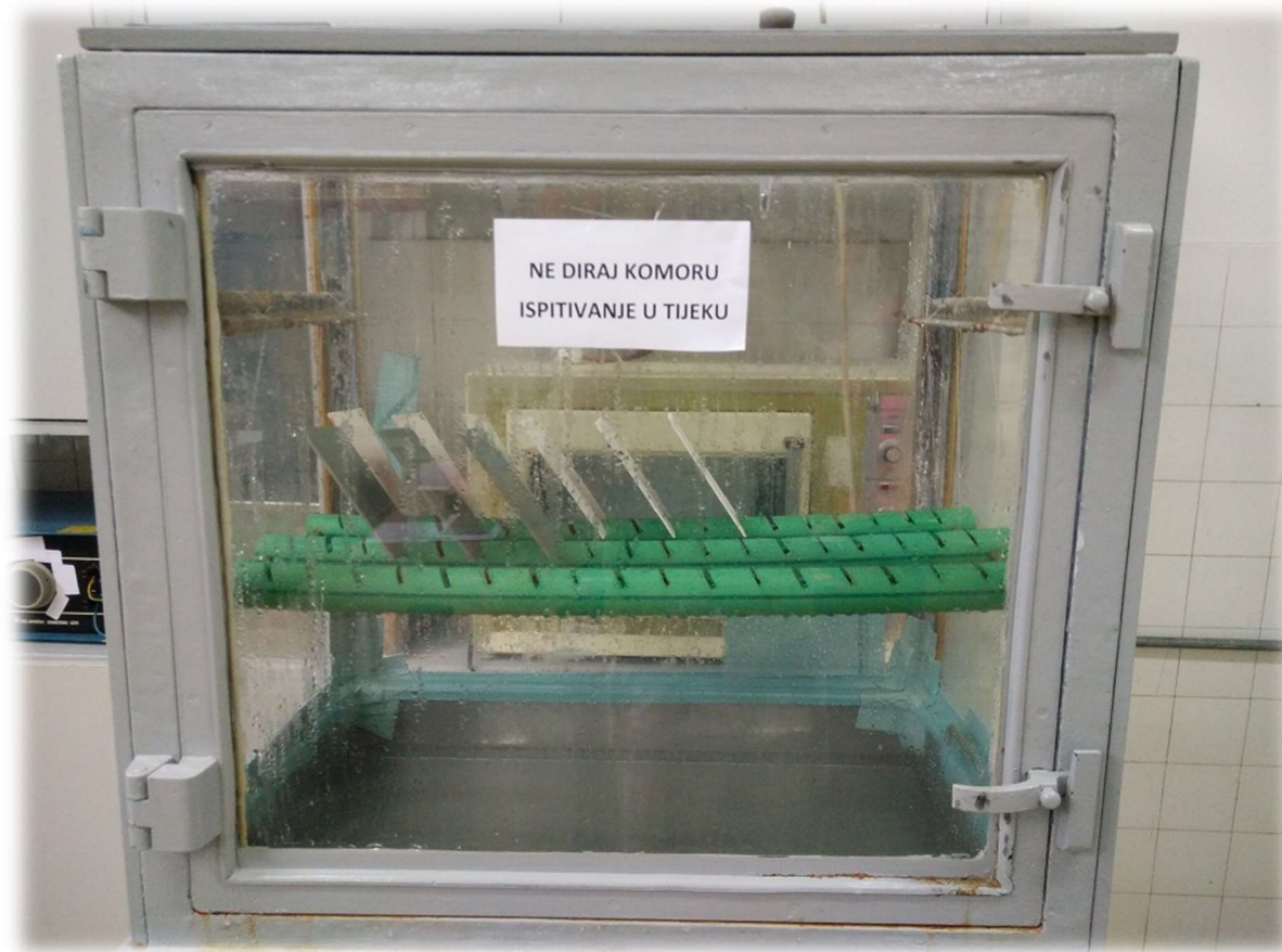
Slika 47. Vlažna komora i uzorci u njoj [10]
