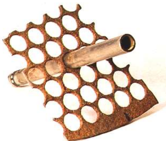
Slika 11. Galvanska korozija nelegiranog čelika (cijevna stijena) u dodiru s nehrđajućim čelikom (cijev) [7]
