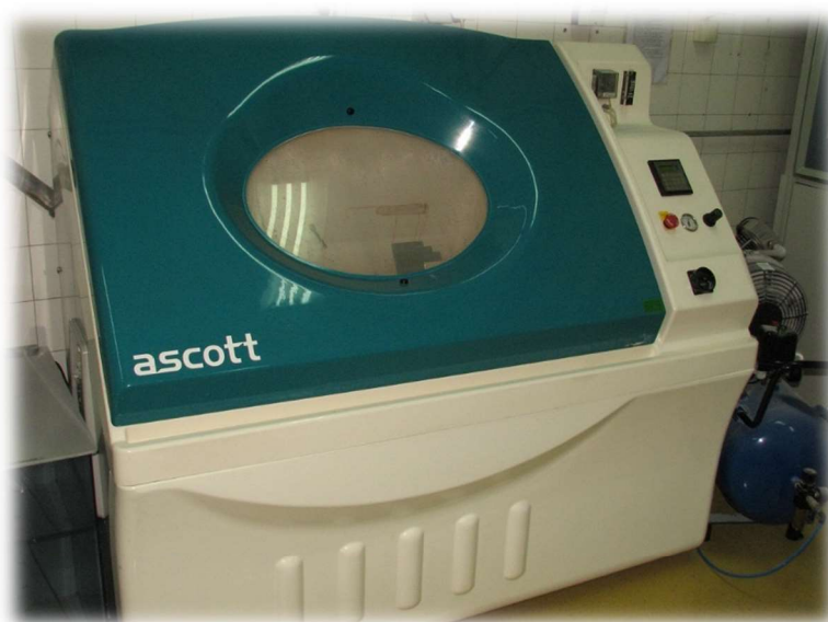
Slika 43. Slana komora Ascott S450, Laboratorij za zaštitu materijala, FSB Zagreb [10]
