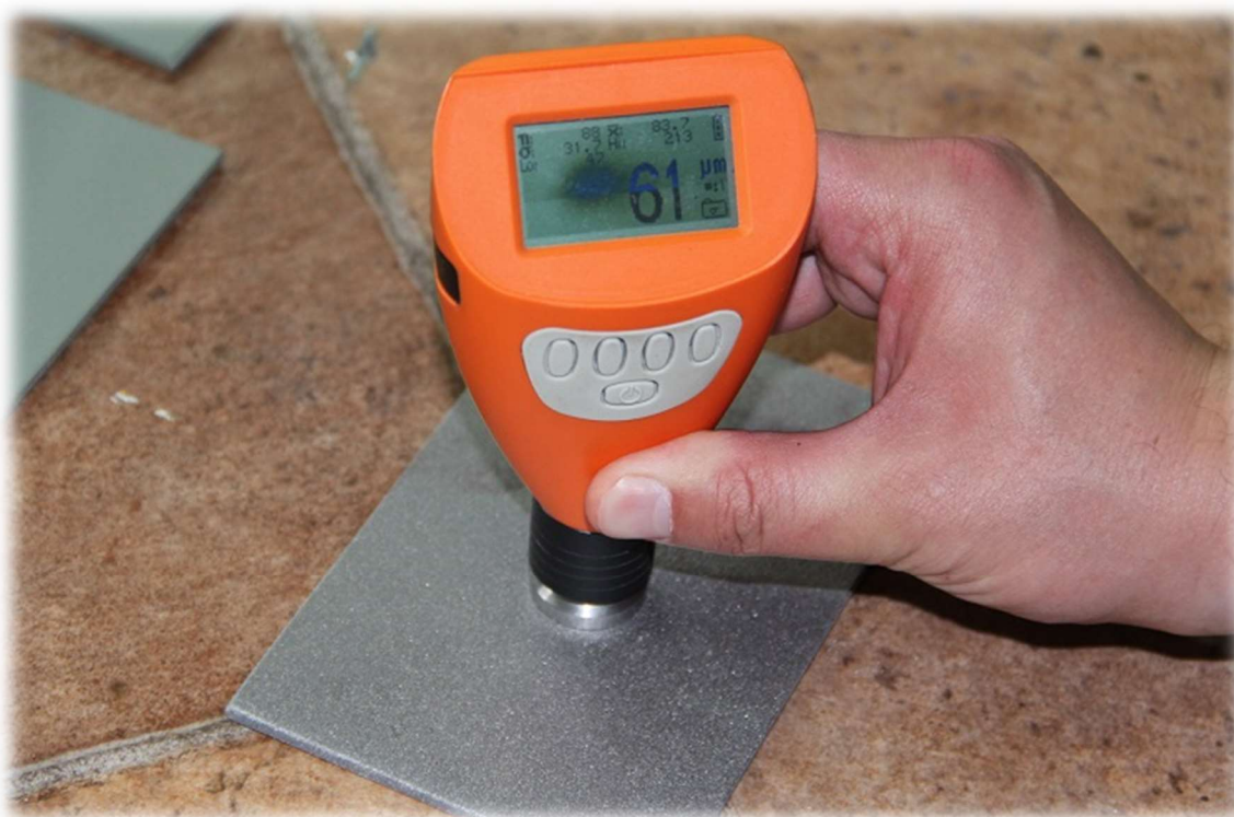
Slika 36. Uzorak 18 i uređaj Elcometer 224 za mjerenje hrapavosti površine [10]
