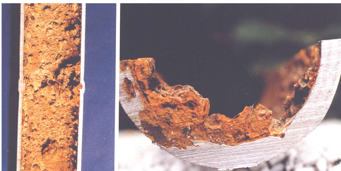
Slika 4. Primjer biološkog oštećivanja [5]
