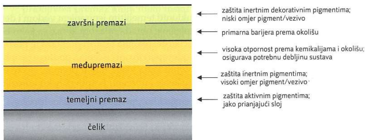
Slika 18. Peteroslojni sustav premaza, ukupne debljine najčešće od 360 do 600 \mu\text{m} [2]
