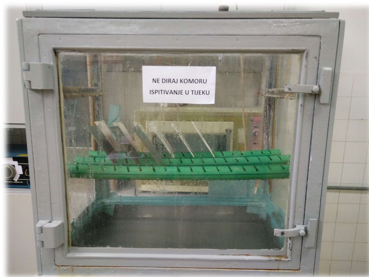
Slika 47. Vlažna komora i uzorci u njoj [10]
