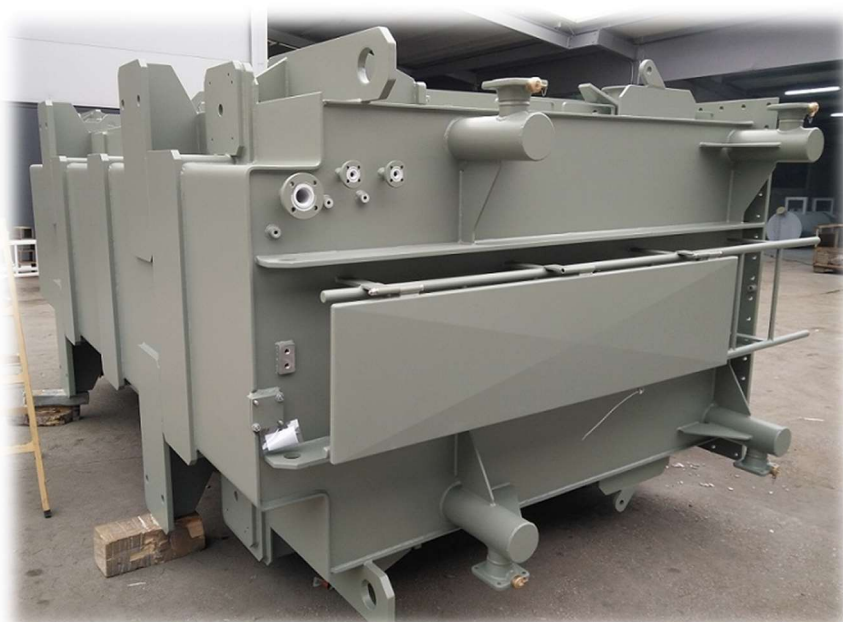
Slika 29. Izgled završnog poliuretanskog premaza, Komet d.o.o. [1]
