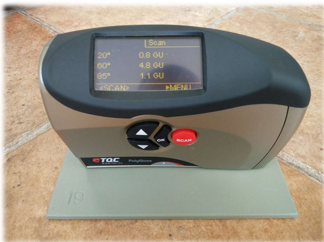
Slika 38. Uređaj Glossmeter TQC GL0030 20°/60°/80° za mjerenje sjaja prevlake [10]
