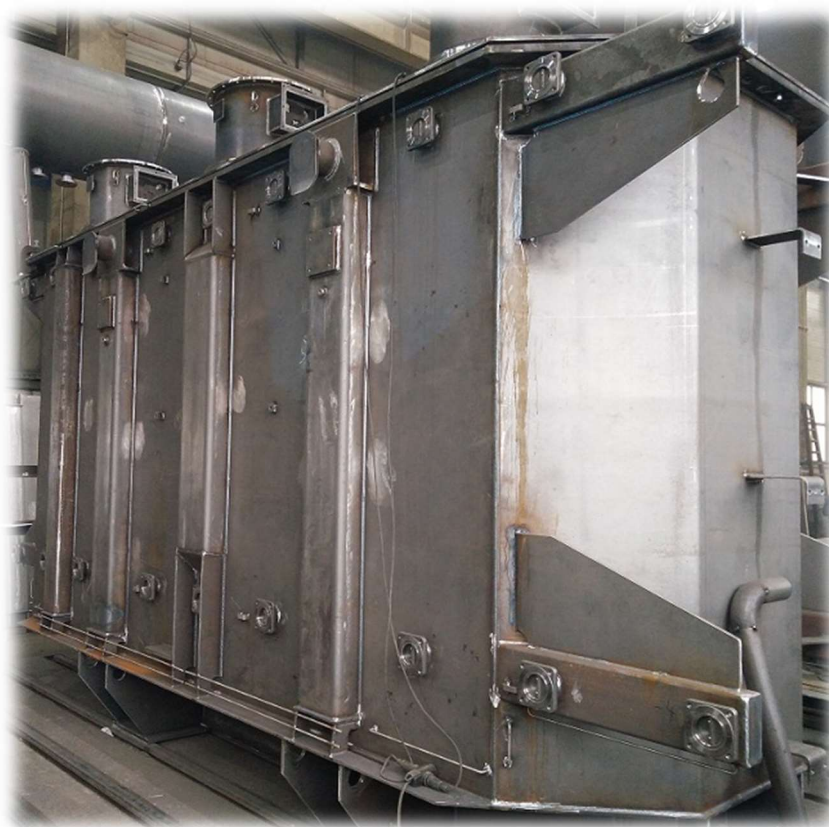
Slika 23. Stanje površine kućišta nakon ispitivanja na nepropusnost sapunicom, Komet d.o.o. [1]
