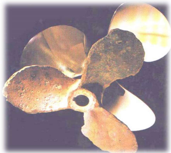
Slika 13. Selektivna korozija, decinkacija mjedi [5]
