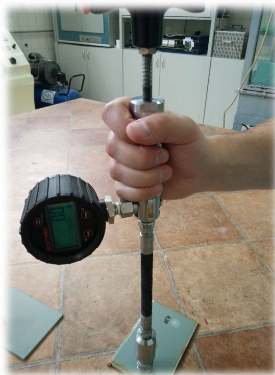
Slika 51. Uređaj Elcometer 108 za ispitivanje vlačne čvrstoće premaza [10]
