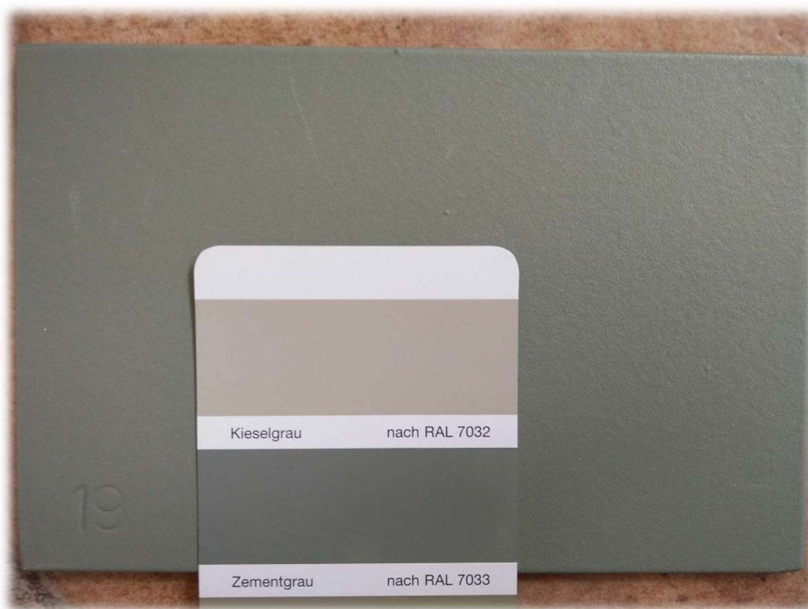
Slika 39. Određivanje nijanse premaza prema RAL-u [10]
