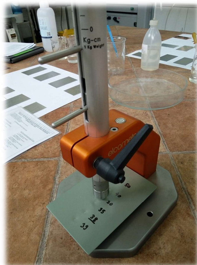
Slika 41. Uređaj Elcometer 1615 za mjerenje otpornosti na udar [10]
