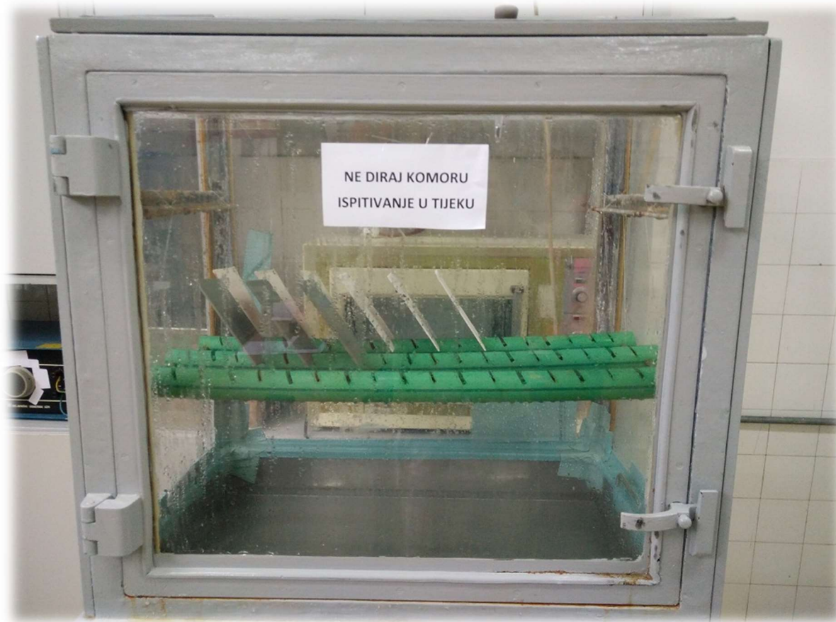
Slika 47. Vlažna komora i uzorci u njoj [10]
