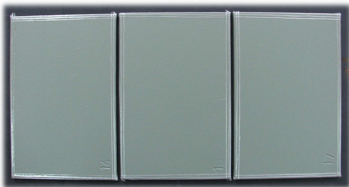
Slika 48. Prikaz pripremljenih uzoraka 14, 16 i 17 za vlažnu komoru [10]
