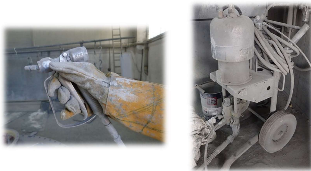
Slika 27. Nanošenje premaza bezračnim postupkom [1]
