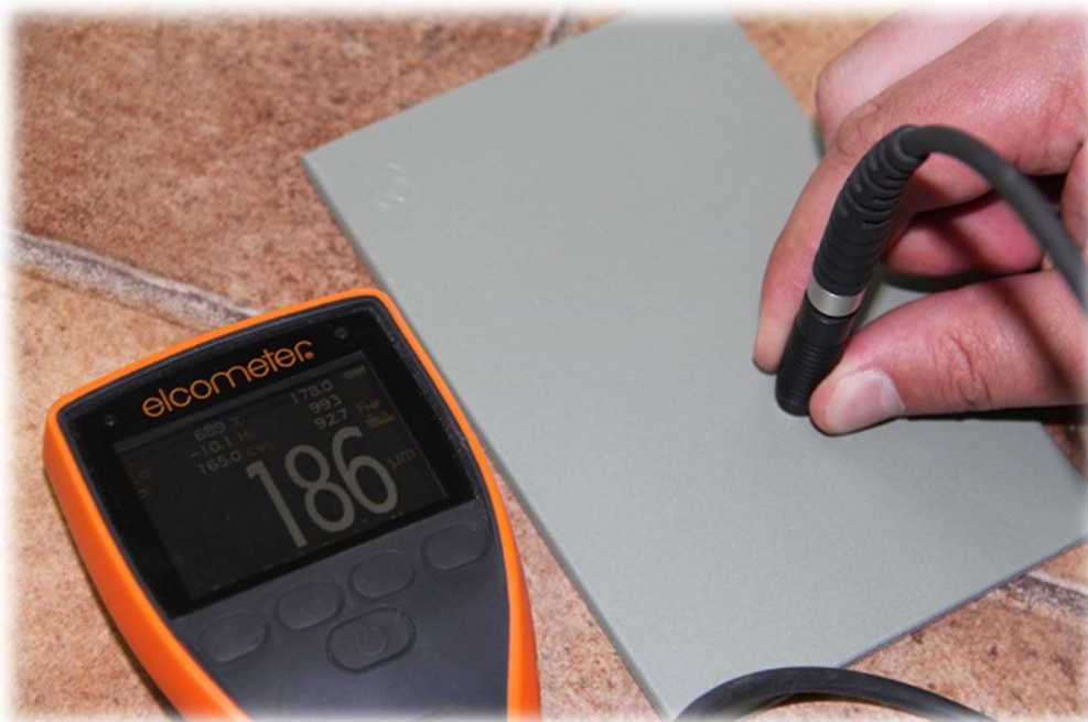
Slika 37. Uređaj Elcometer 456 za mjerenje debljine prevlake [10]
