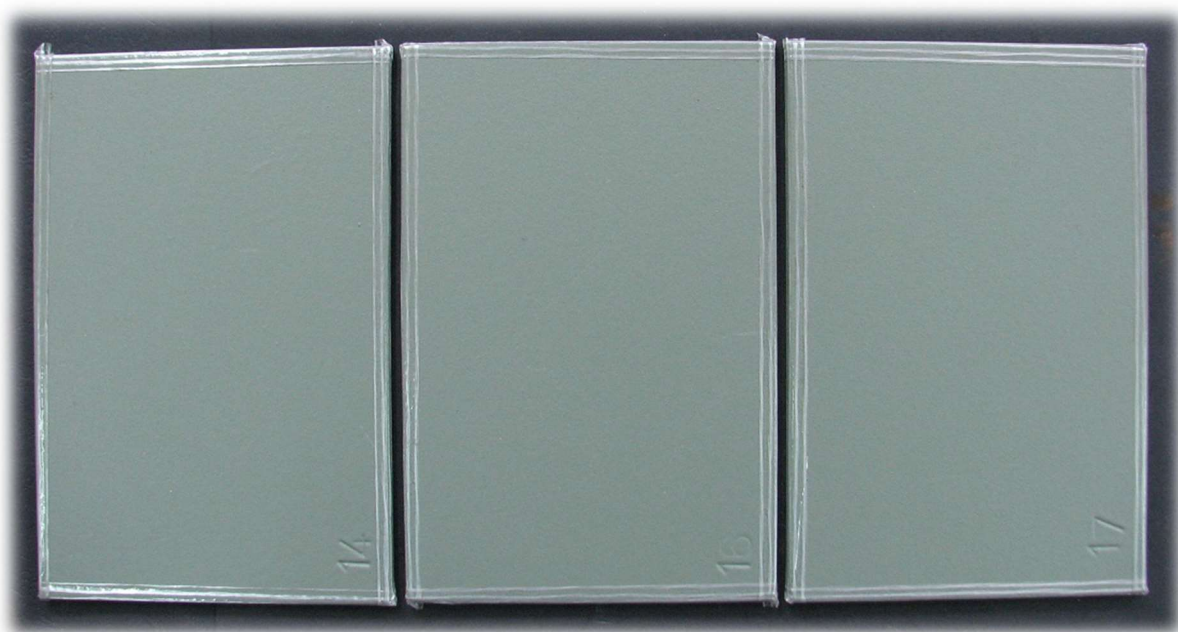
Slika 48. Prikaz pripremljenih uzoraka 14, 16 i 17 za vlažnu komoru [10]
