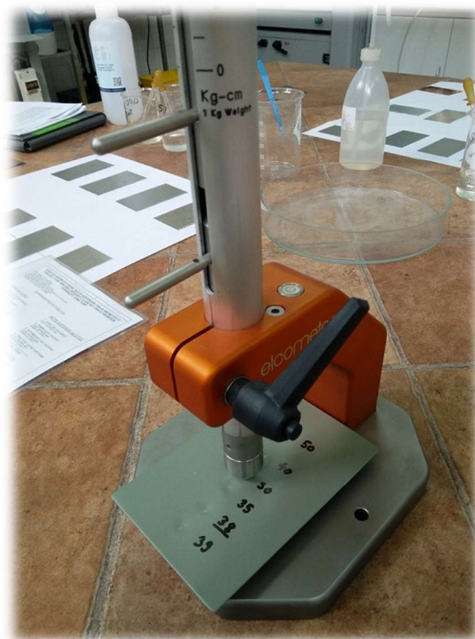
Slika 41. Uređaj Elcometer 1615 za mjerenje otpornosti na udar [10]
