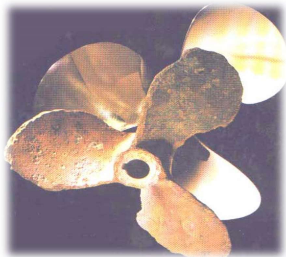
Slika 13. Selektivna korozija, decinkacija mjedi [5]
