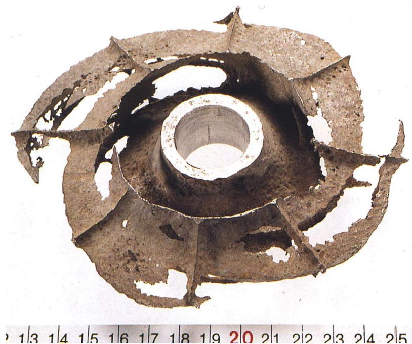
Slika 3. Primjer mehaničkog kavitacijskog oštećivanja [5]
