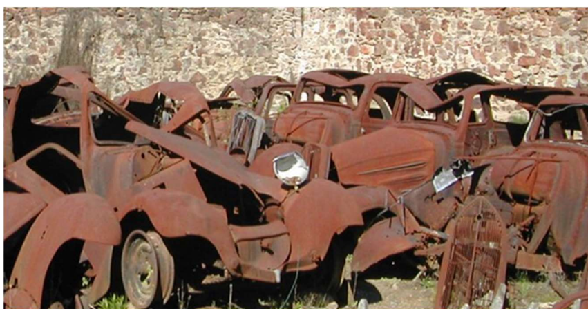
Slika 2. Primjer kemijskog oštećivanja atmosferskom korozijom [5]
