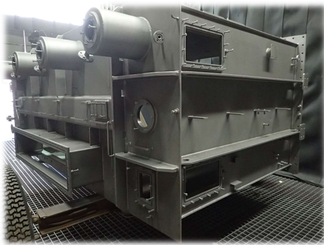
Slika 24. Stanje površine kućišta nakon sačmarena, Komet d.o.o. [1]
