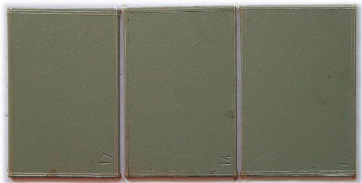
Slika 49. Prikaz uzoraka 14, 16 i 17 nakon 240 h ispitivanja u vlažnoj komori [10]
