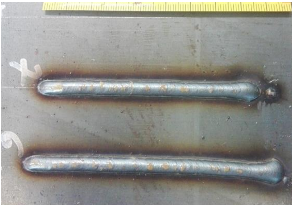
Slika 45. Navari 6 i 7 dobiveni pri snimanju dinamičkih karakteristika funkcije Constant penetration
