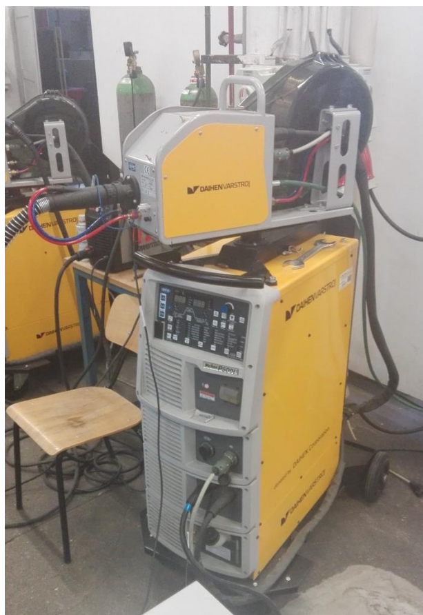
Slika 26. Izvor struje OTC Daihen Welbee P500L
