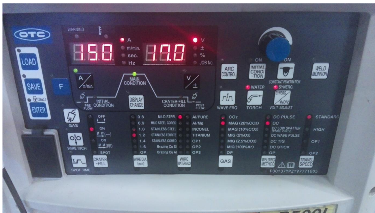
Slika 28. Parametri zavarivanja za konstrukcijski čelik
