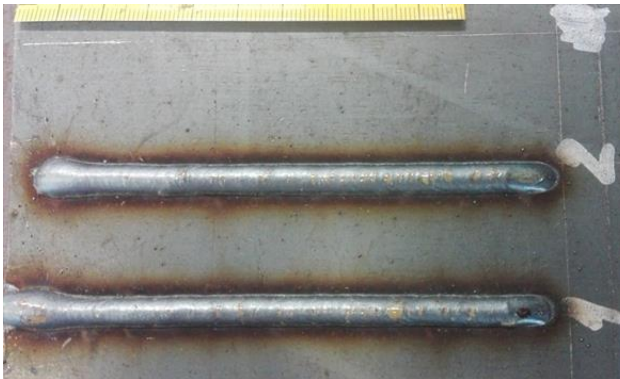
Slika 44. Navari 1 i 2 dobiveni pri snimanju dinamičkih karakteristika funkcije Constant penetration
