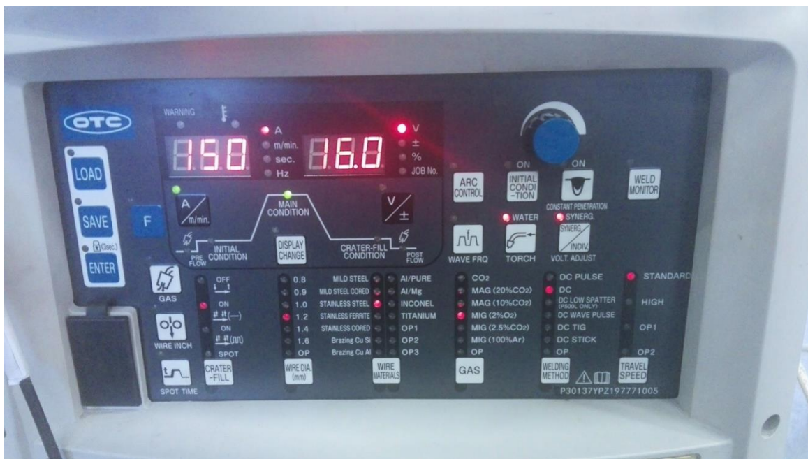
Slika 29. Parametri zavarivanja pri zavarivanju nehrđajućeg čelika
