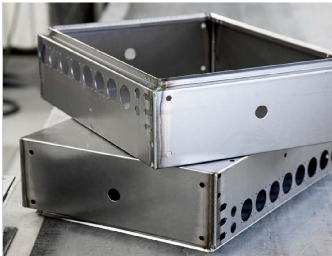
Slika 12. Proizvod zavaren uz pomoć funkcije WiseThin™ [15]
