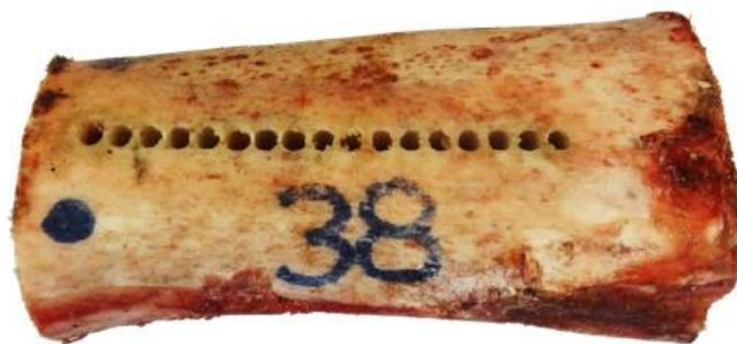
Slika 6. Ispitni uzorak nakon bušenja
