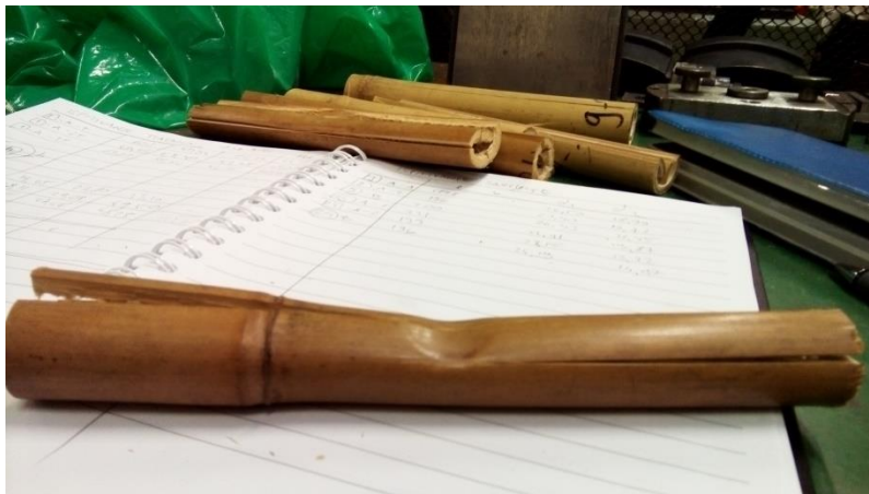
Slika 59. Uzorak opterećen na savijanje
