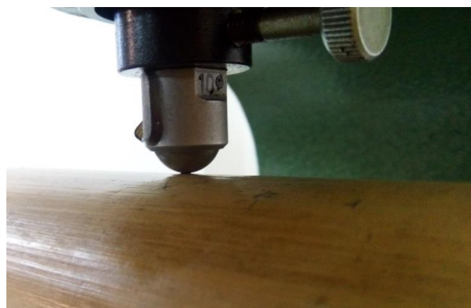
Slika 43. Ispitivanje tvdoće bambusa
