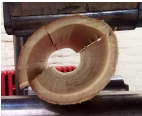
Slika 60. Lom uzorka 3-A-2
