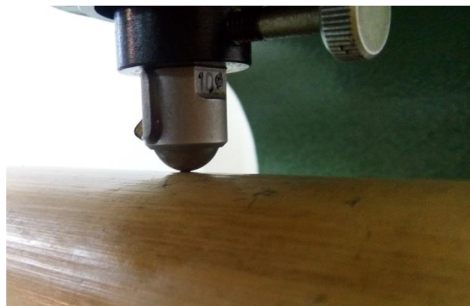
Slika 43. Ispitivanje tvdoće bambusa
