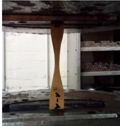
Slika 53. Vlačno opterećeni uzorak
