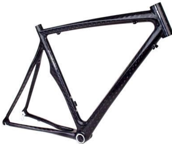
Slika 11. Okvir od kompozita s ugljičnim vlaknima [25]
