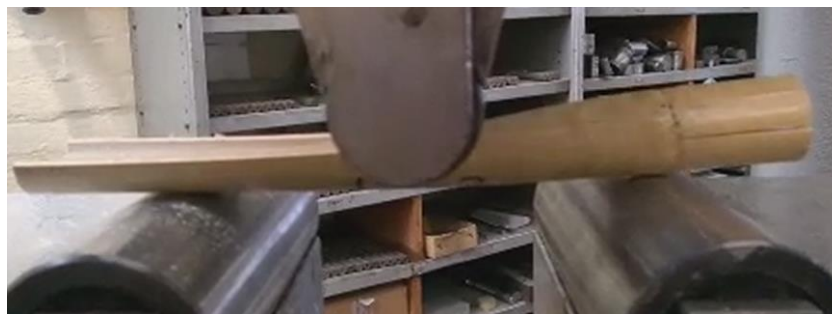
Slika 40. Lom uslijed savijanja uzorak 13-2
