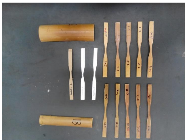
Slika 29. Uzorci spremni za ispitivanje
