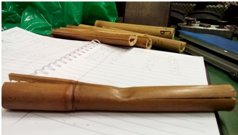
Slika 59. Uzorak opterećen na savijanje
