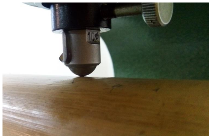
Slika 43. Ispitivanje tvdoće bambusa
