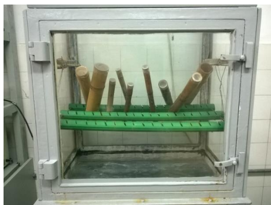
Slika 52. Uzorci u vlažnoj komori
