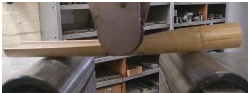
Slika 40. Lom uslijed savijanja uzorak 13-2
