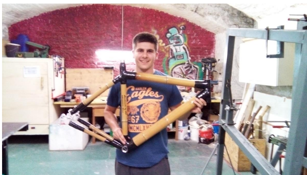
Slika 67. Izrađeni okvir od bambusa i ugljičnih vlakana
