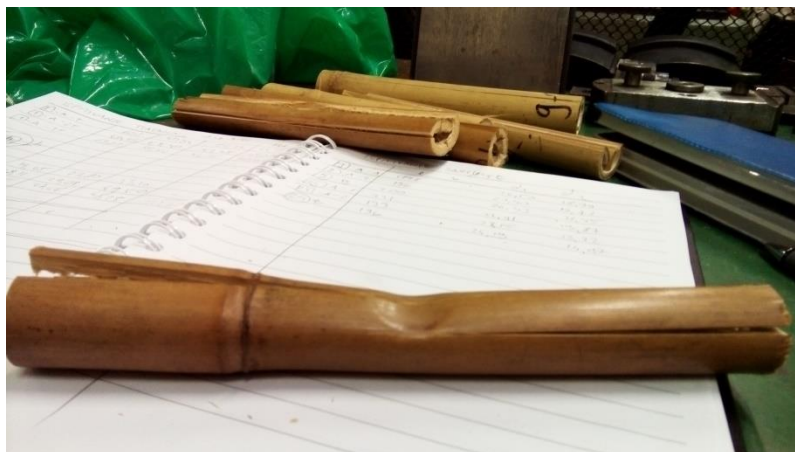
Slika 59. Uzorak opterećen na savijanje
