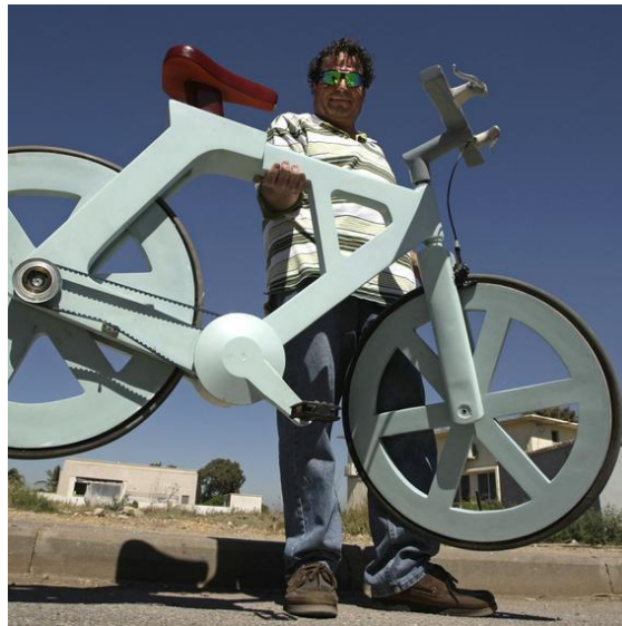
Slika 13. Bicikl od kartona tvrtke Cardboard Technologies [30]
