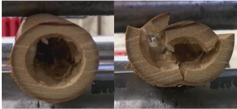
Slika 39. Lom uslijed savijanja uzorak 25-3
