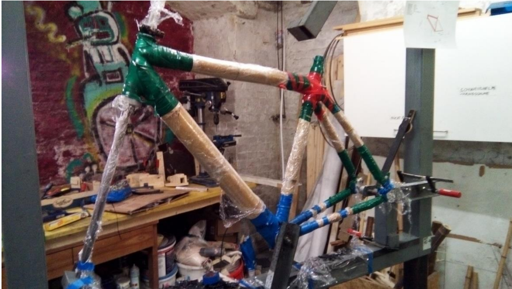
Slika 64. Nanošenje trake na kompozit s ugljičnim vlaknima
