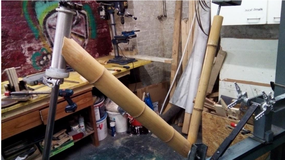
Slika 62. Postavljanje cijevi na napravu
