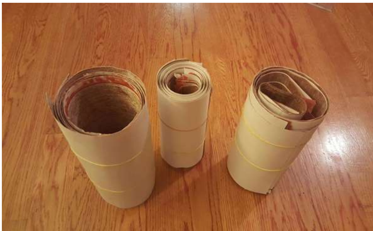
Slika 47. Izrezani slojevi od lanenog preprega
