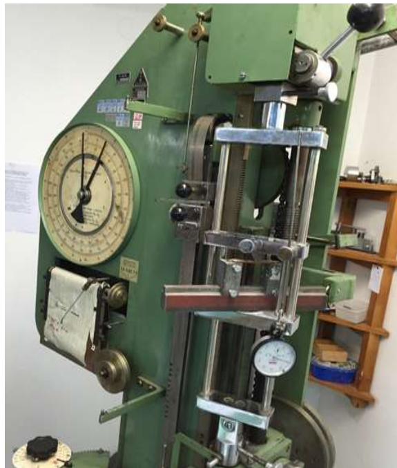
Slika 69. Trotočkasto savojno ispitivanje na kidalici
