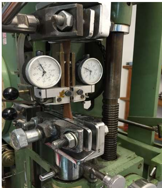
Slika 65. Kidalica na kojoj je izvršeno vlačno ispitivanje
