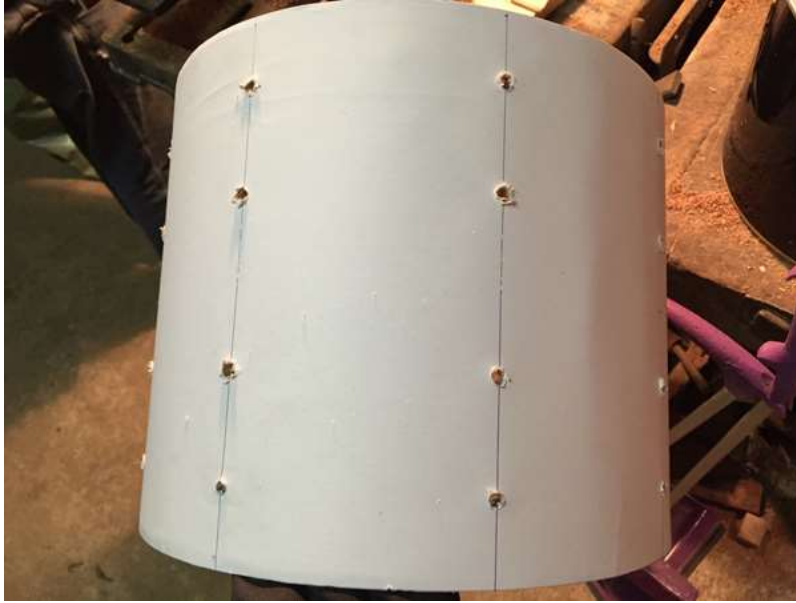
Slika 61. Skicirane i izbušene rupe
