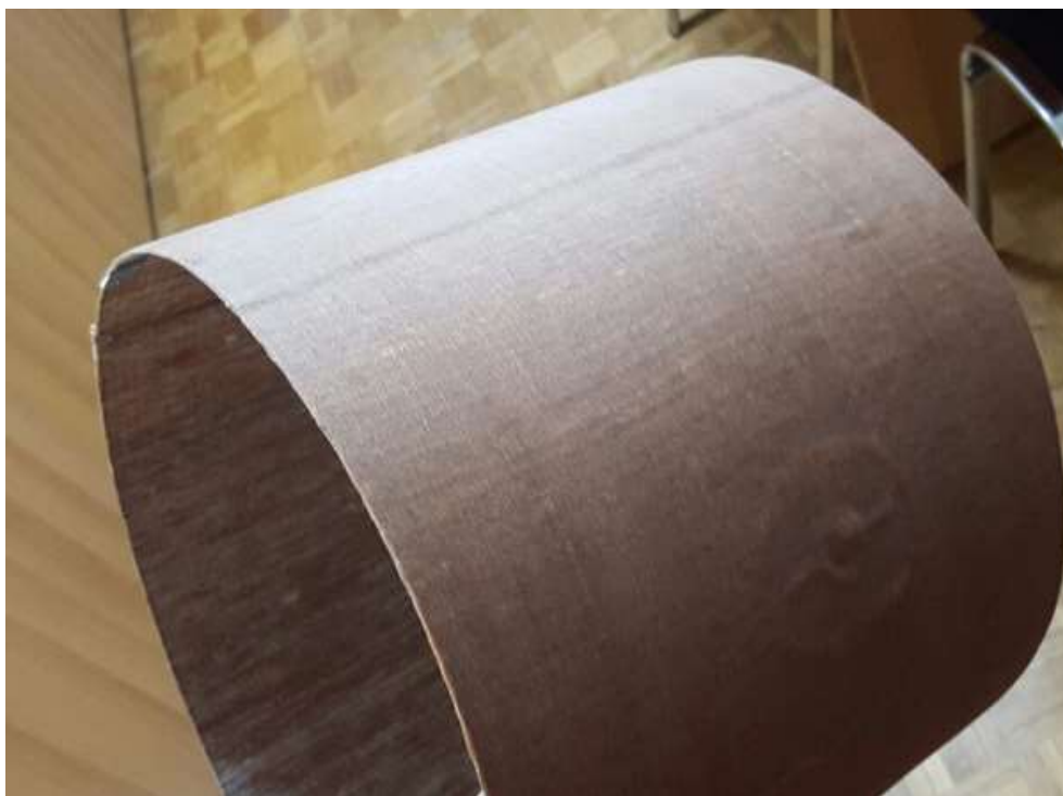
Slika 55. Dobivena stijenka bubnja od lanenog kompozita
