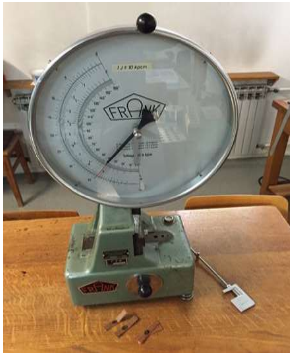
Slika 73. Ispitivanje žilavosti na Charpyjevom batu
