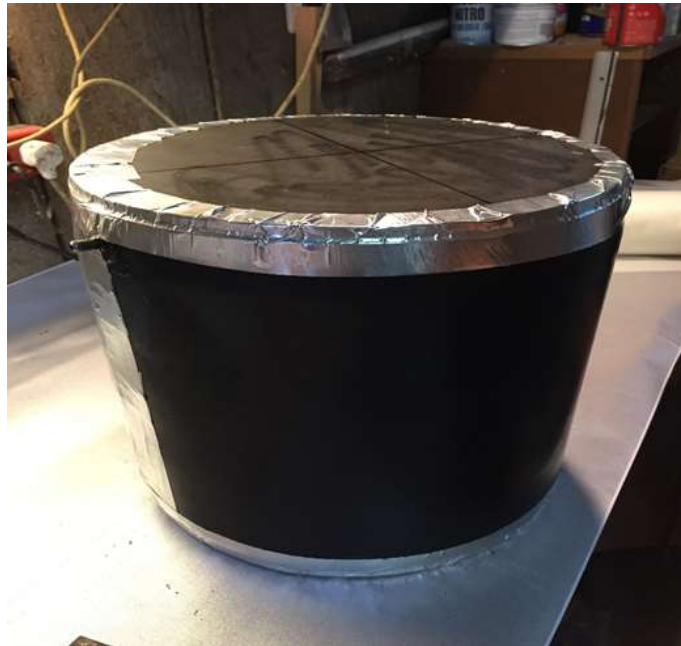
Slika 57. Slojevi kompozita napregnuti gumom i zabrtvljeni Al trakom
