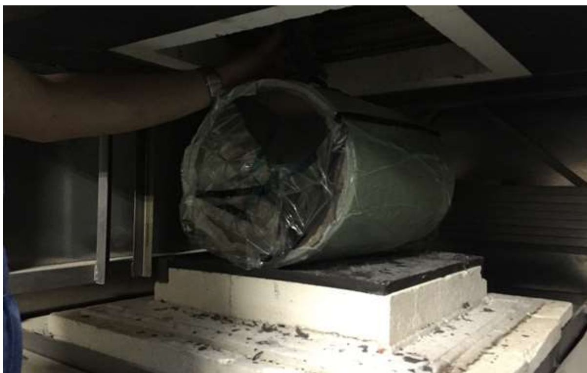
Slika 53. Polaganje omotanog kalupa u peć
