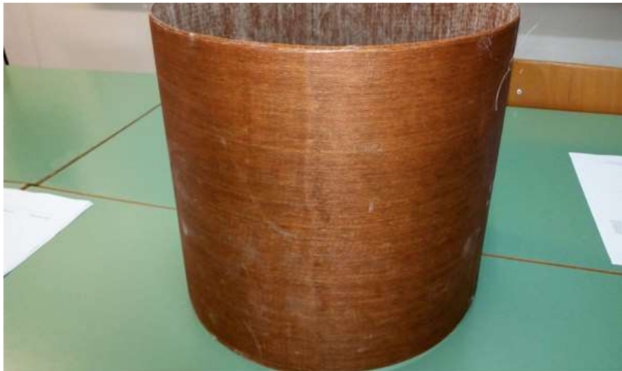
Slika 56. Druga stijenka od lanenog kompozita
