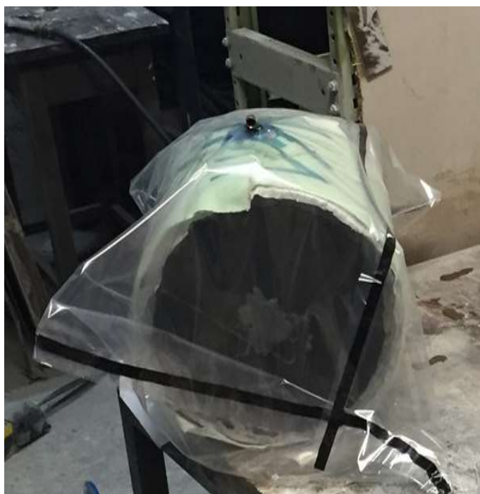
Slika 51. Kalup zabrtvljen PA folijom
