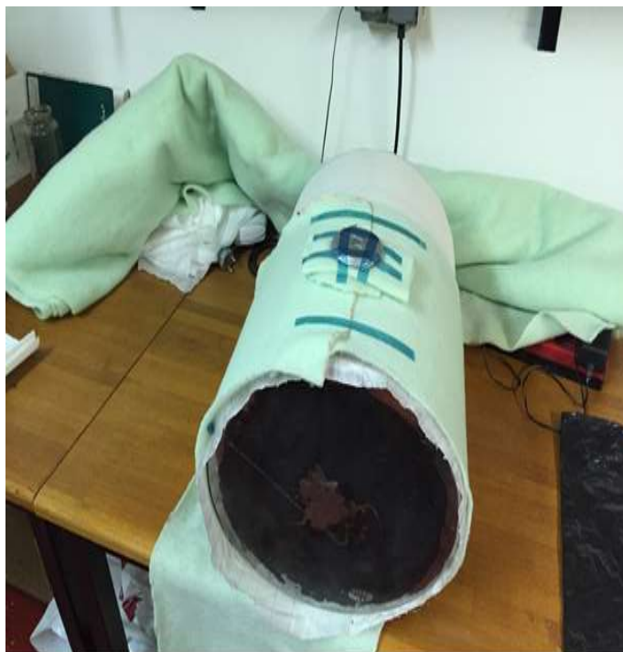
Slika 50. Omotana tkanina za upijanje prekomjerne smole
