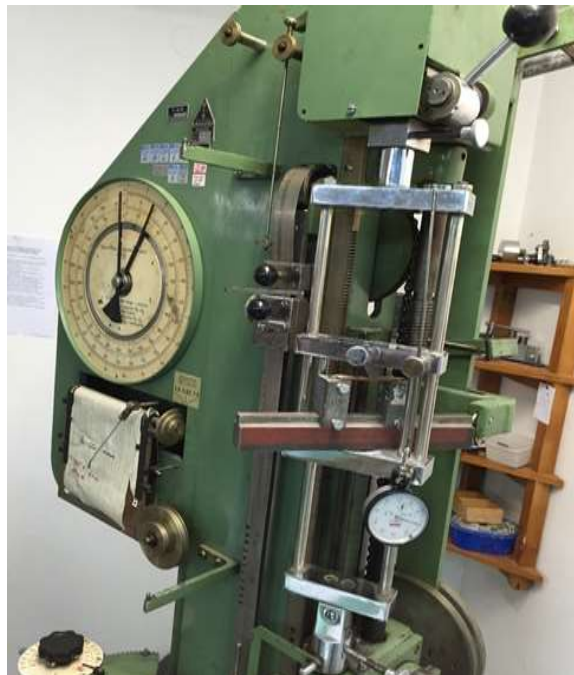
Slika 69. Trotočkasto savojno ispitivanje na kidalici
