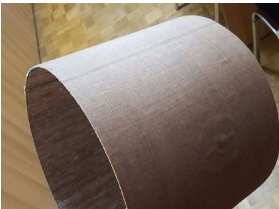
Slika 55. Dobivena stijenka bubnja od lanenog kompozita
