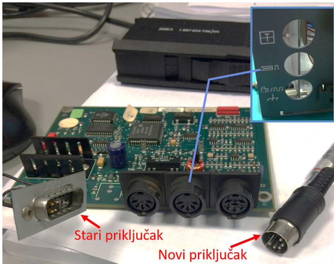
Slika 3.6 Modul za spajanje dodatnih senzora sa starim i novim priključkom
