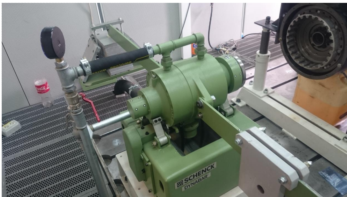
Slika 8.14 Detalji iz postupka umjeravanja momenta kočnice utezima
