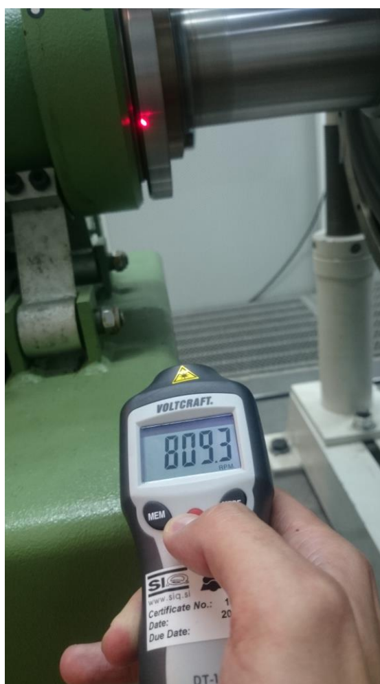
Slika 8.23 Mjerenje brzine vrtnje uređajem Voltcraft DT-10L
