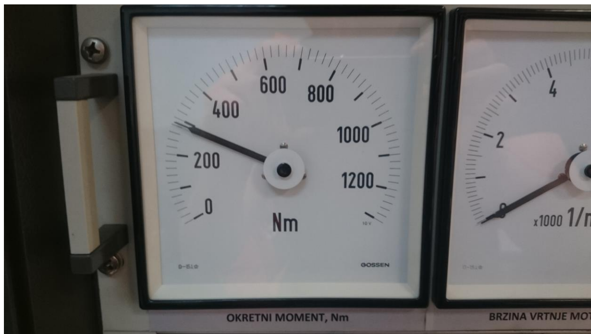
Slika 8.9 Analogni prikaz momenta na upravljačkom ormaru kočnice
