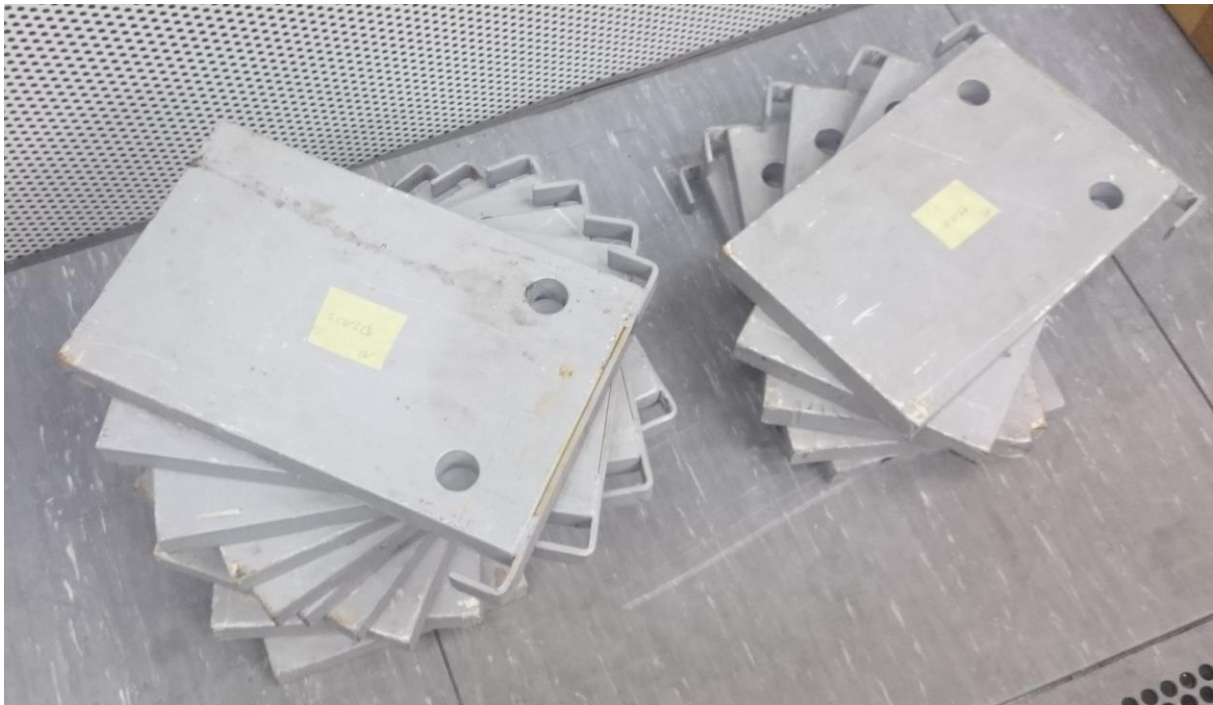
Slika 8.13 Priručni utezi upotrijebljeni u postupku preliminarnog umjeravanja
