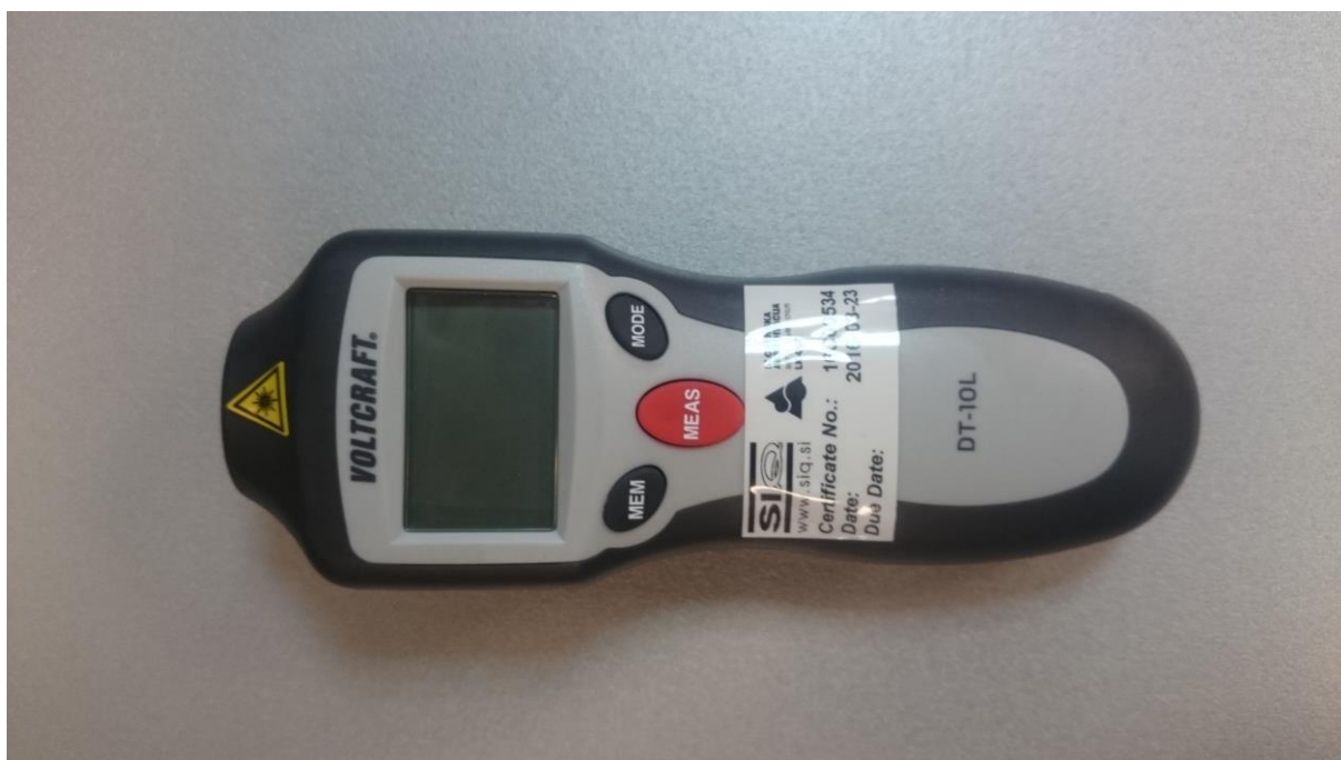
Slika 8.21 Uređaj za mjerenje brzine vrtnje Voltcraft DT-10L
