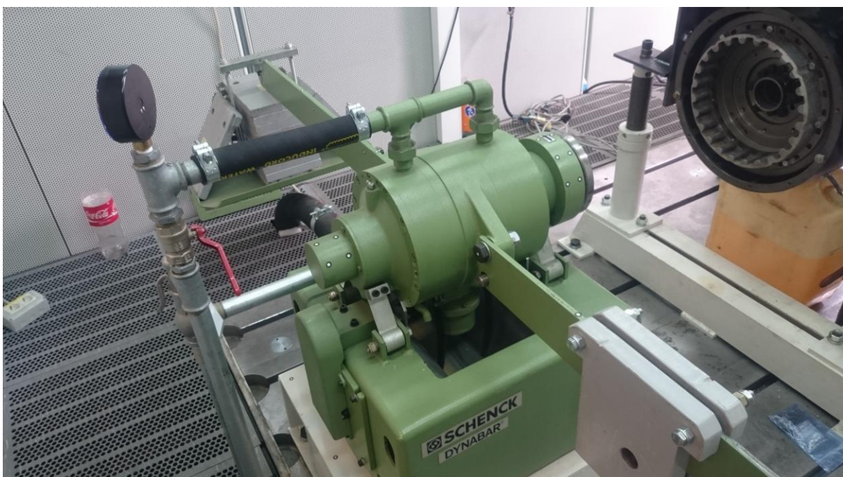
Slika 8.14 Detalji iz postupka umjeravanja momenta kočnice utezima
