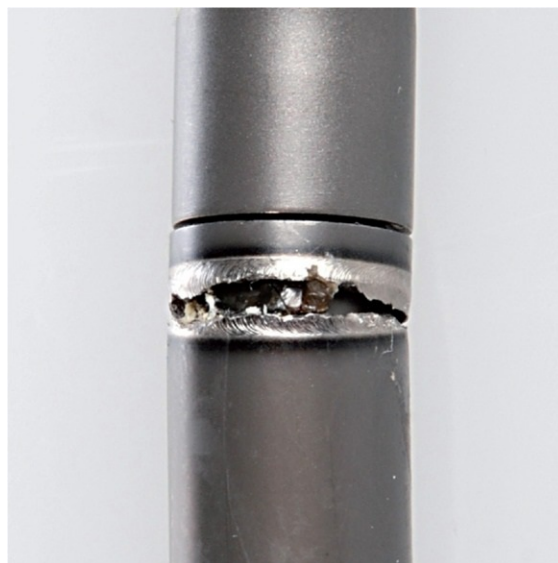
Slika 4.9 Puknuće Ellipse Precise implantata na mjestu zavora [14]
