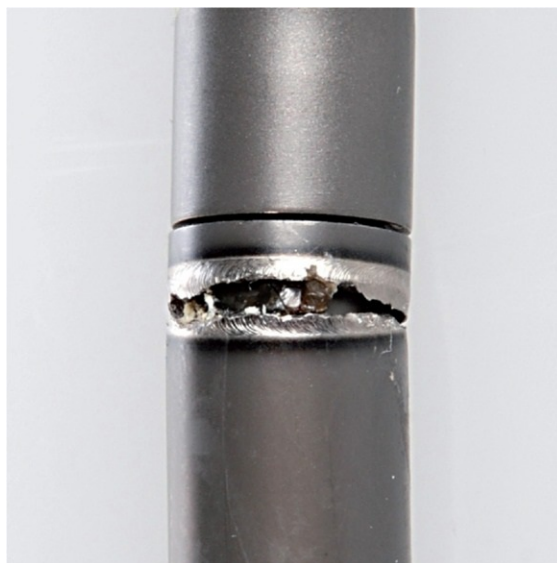
Slika 4.9 Puknuće Ellipse Precise implantata na mjestu zavora [14]
