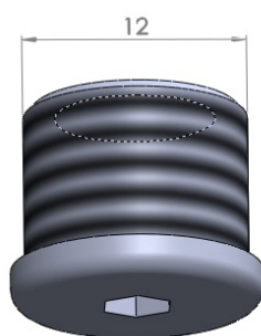
Slika 7.6 Čep za zatvaranje nakon ugradnje
