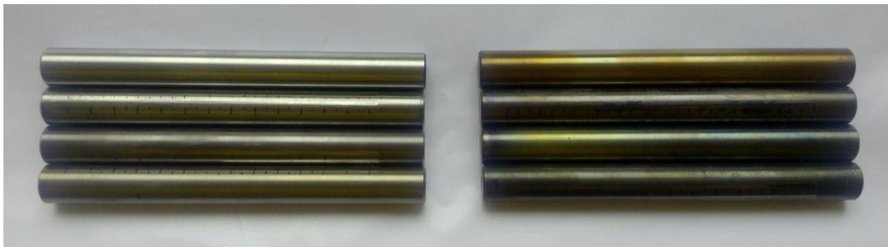
Slika 28. Uzorci za "load scanning" ispitivanje
