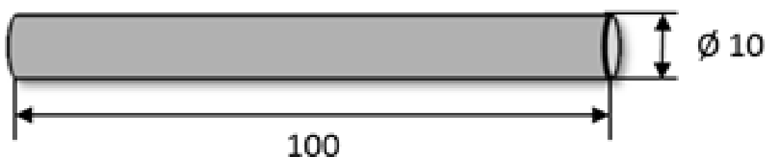
Slika 25. Uzorak za „load scanning“ ispitivanje
