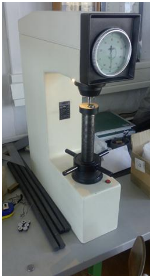
Slika 26. Tvrdomjer za ispitivanje prionjivosti prevlaka
