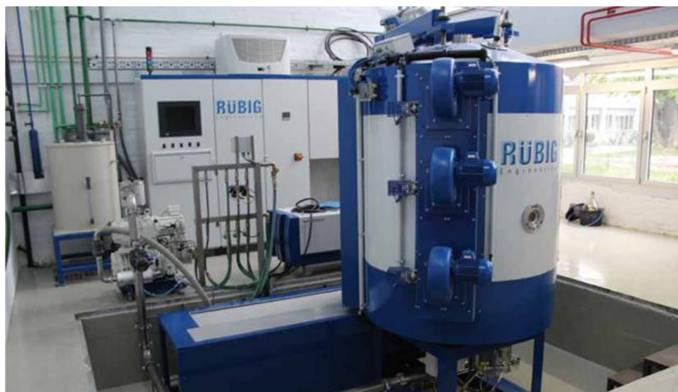
Slika 14. Uredaj za plazmatsko nitriranje i PACVD prevlačenje instaliran na Fakultetu strojarstva i brodogradnje u Zagrebu [13]
