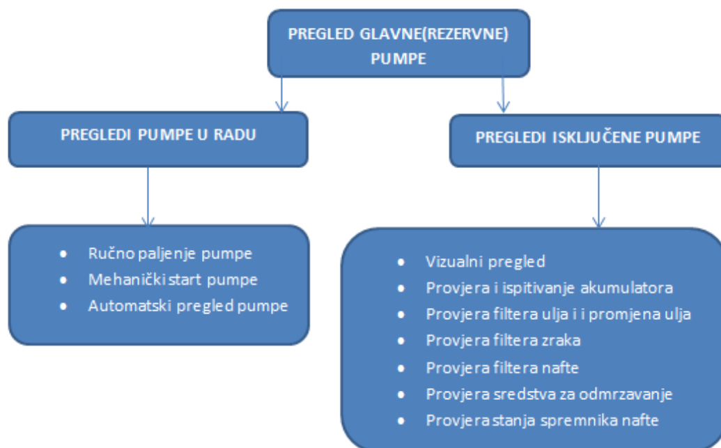
Slika 26. Pregledi pumpe s obzirom na operacijsko stanje pumpe
