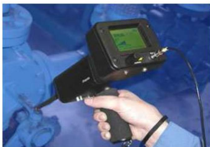
Slika 4. Ultrazvučno mjerjenje [1]
