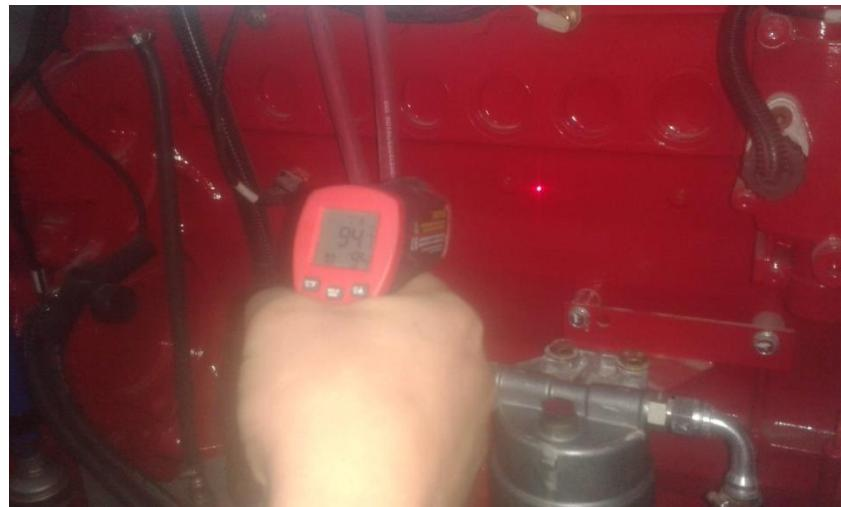
**Slika 32. Mjerenje temperaturne pumpe u radu**
