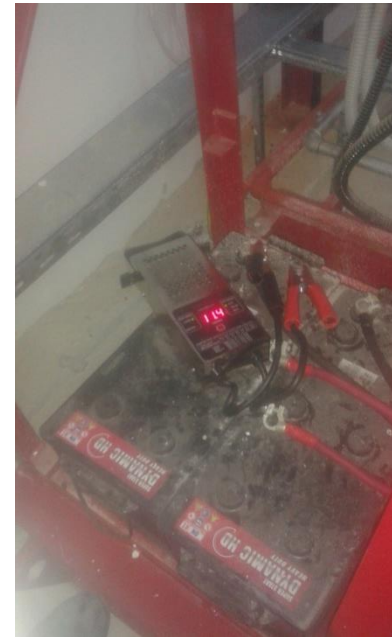
Slika 27. Ispitivanje napona akumulatora voltmetrom
