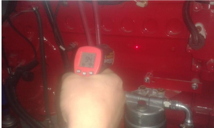
Slika 32. Mjerenje temperatura pumpe u radu
