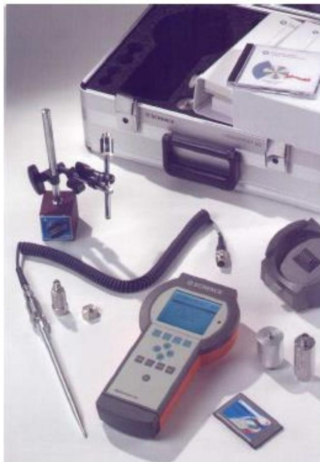
Slika 5. Uređaj za mjerjenje vibracija Vibrotest [1]
