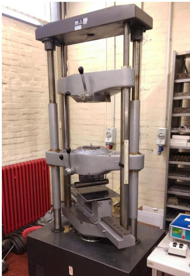
**Slika 5.17. Postav spreman za ispitivanje savijanja**
