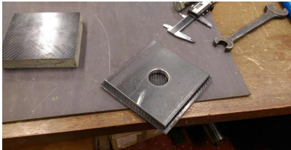
Slika 5.23. Podloga za ispitno tijelo smične čvrstoće
