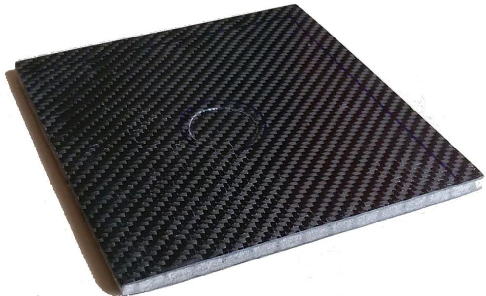
**Slika 5.30.** Pukotina gornje ljsuske tanje sendvič strukture uslijed smičnog opterećenja
