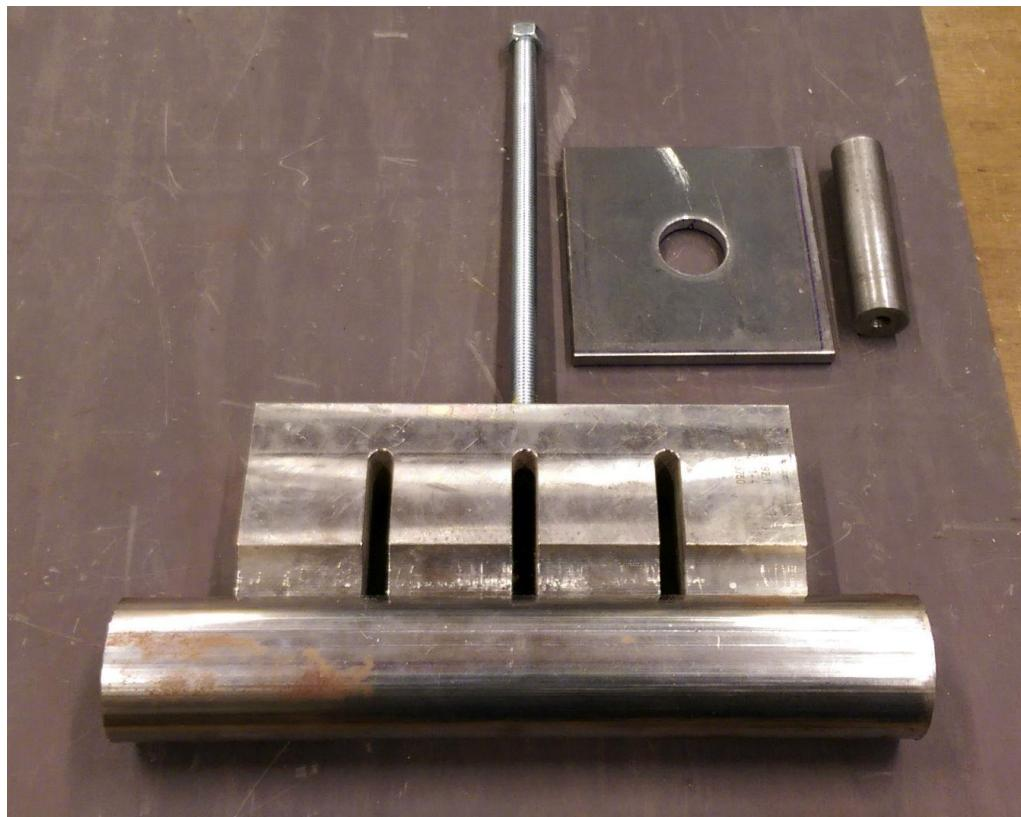
**Slika 5.16. Pripremljeni elementi za smično i savojno ispitivanje**
