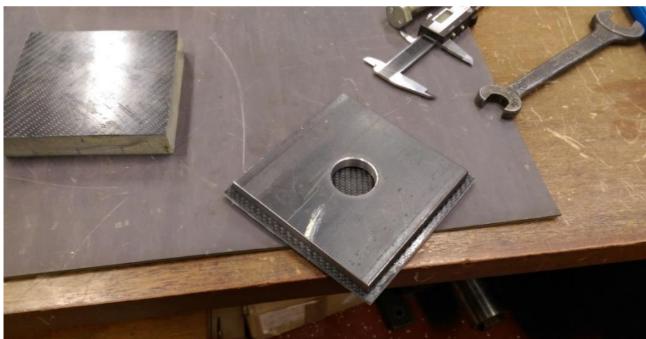
Slika 5.23. Podloga za ispitno tijelo smične čvrstoće
