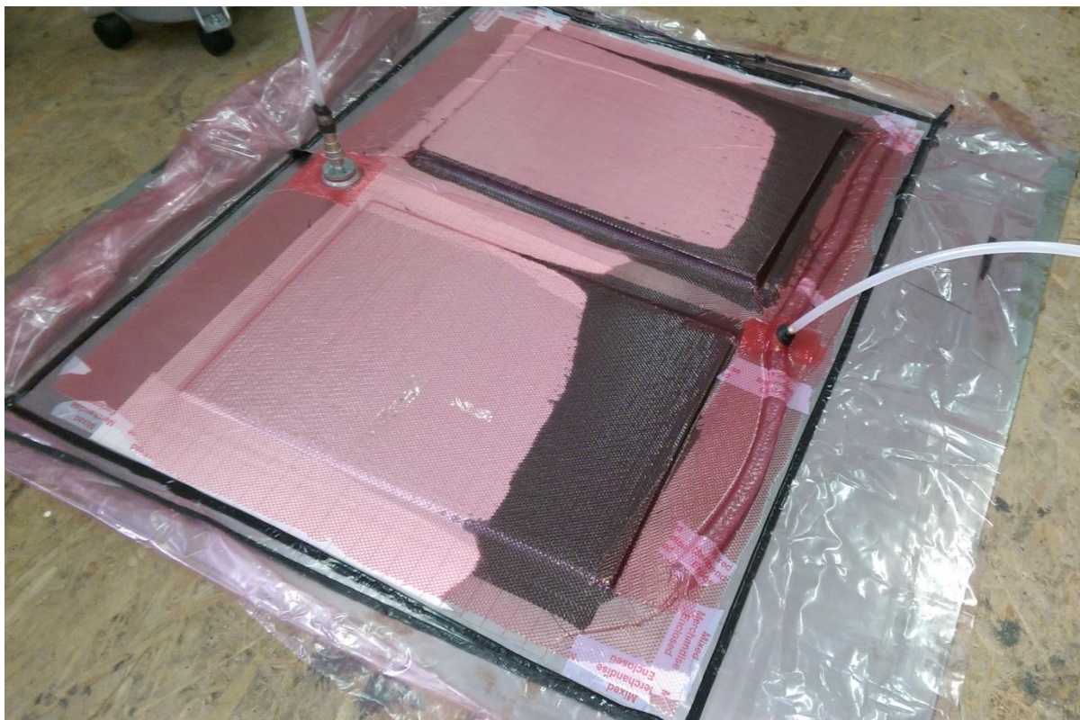
Slika 5.10. Popunjavanje laminata smolom kroz razdoblje od 5 minuta
