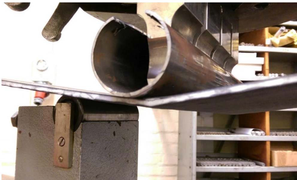
Slika 5.19. Lom jezgre sendvič strukture
