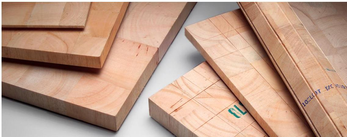
**Slika 4.18. Ploče balze pripremljene za sendvič strukture [16]**
