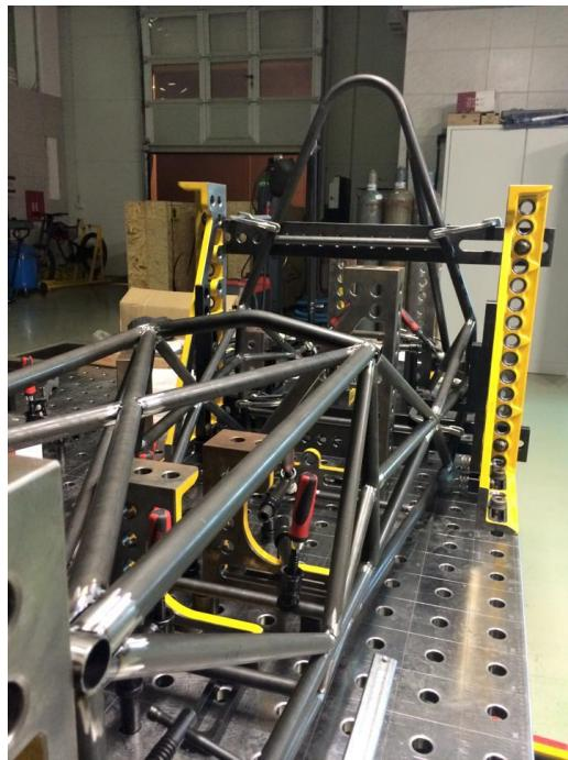
**Slika 2.9. Nosiva konstrukcija na zavarivačkom stolu**
