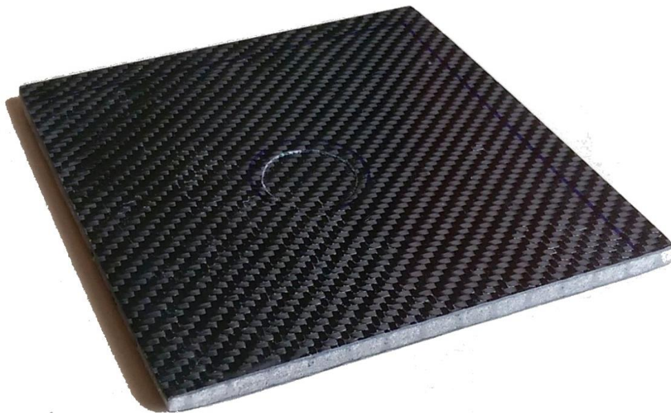
Slika 5.30. Pukotina gornje ljuske tanje sendvič strukture uslijed smičnog opterećenja
