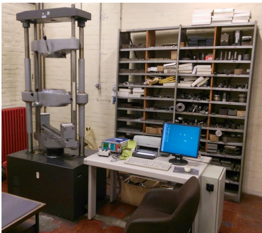
Slika 5.15. Kidalica WPM Heckert 400kN
