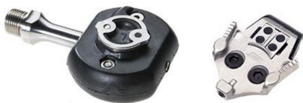
Slika 22. Speedplay Frog pedala i blokej [18]
