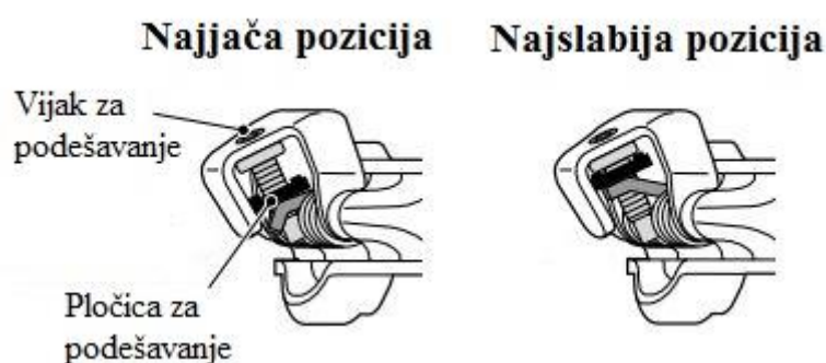
Slika 16. Primjer podešenosti do dvije krajnje pozicije [15]
