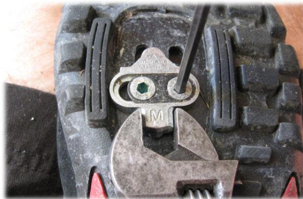
Slika 14. Blago zarotiran blokej, SPD pedala [2]
