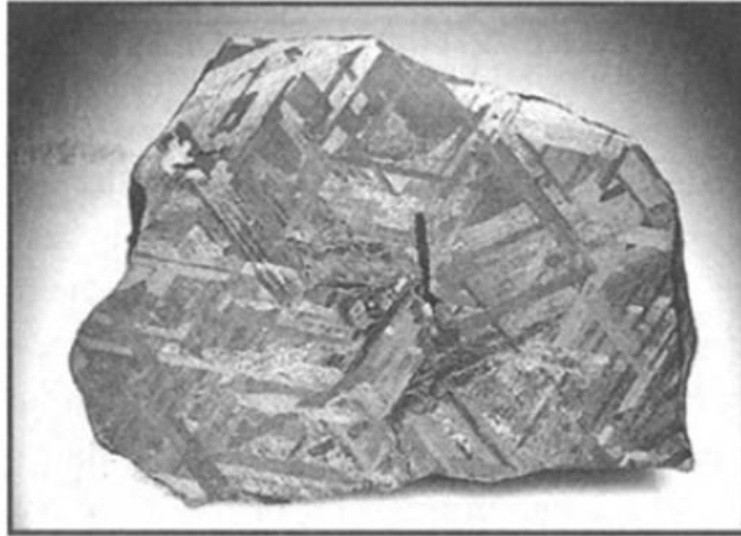
Slika 2. Widmanstättenova struktura iz meteorita u Australiji
