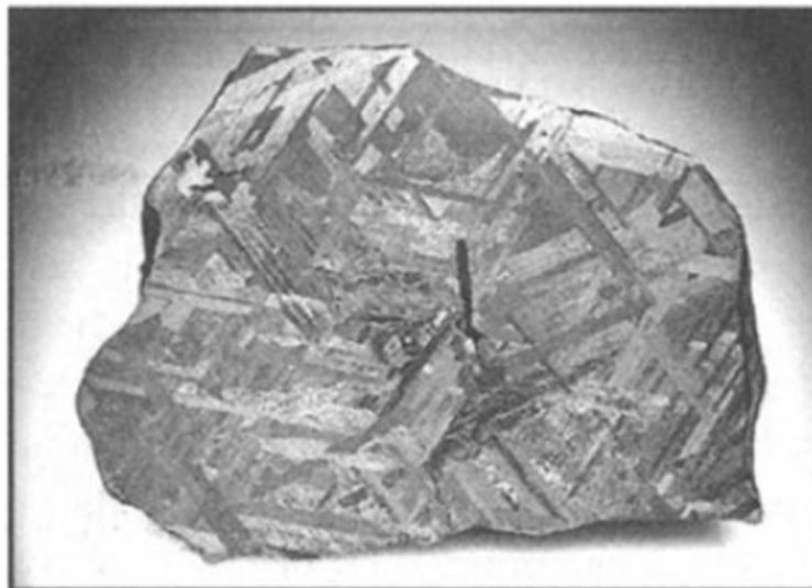
Slika 2. Widmanstättenova struktura iz meteorita u Australiji
