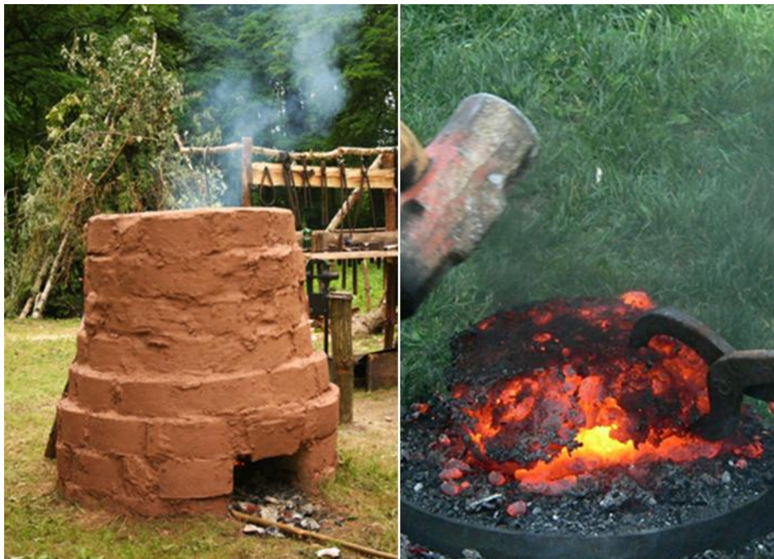
Slika 6. Plitko ognjište (lijevo) i spužvasto željezo izvađeno iz donjeg dijela plitkog ognjišta (desno)
