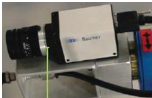
Slika 78. Kamera za vizijski sustav MotoSight 3D [17]
