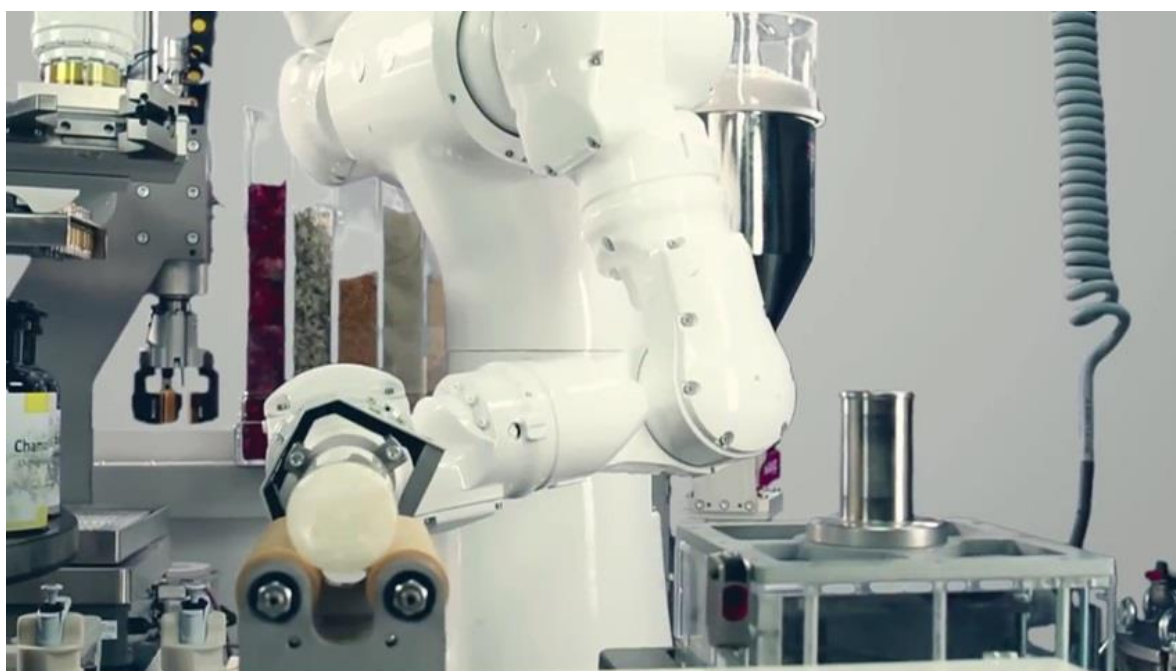
Slika 69. Lijepljenje etikete na ambalažu položenu na rotirajuće valjke [14]
