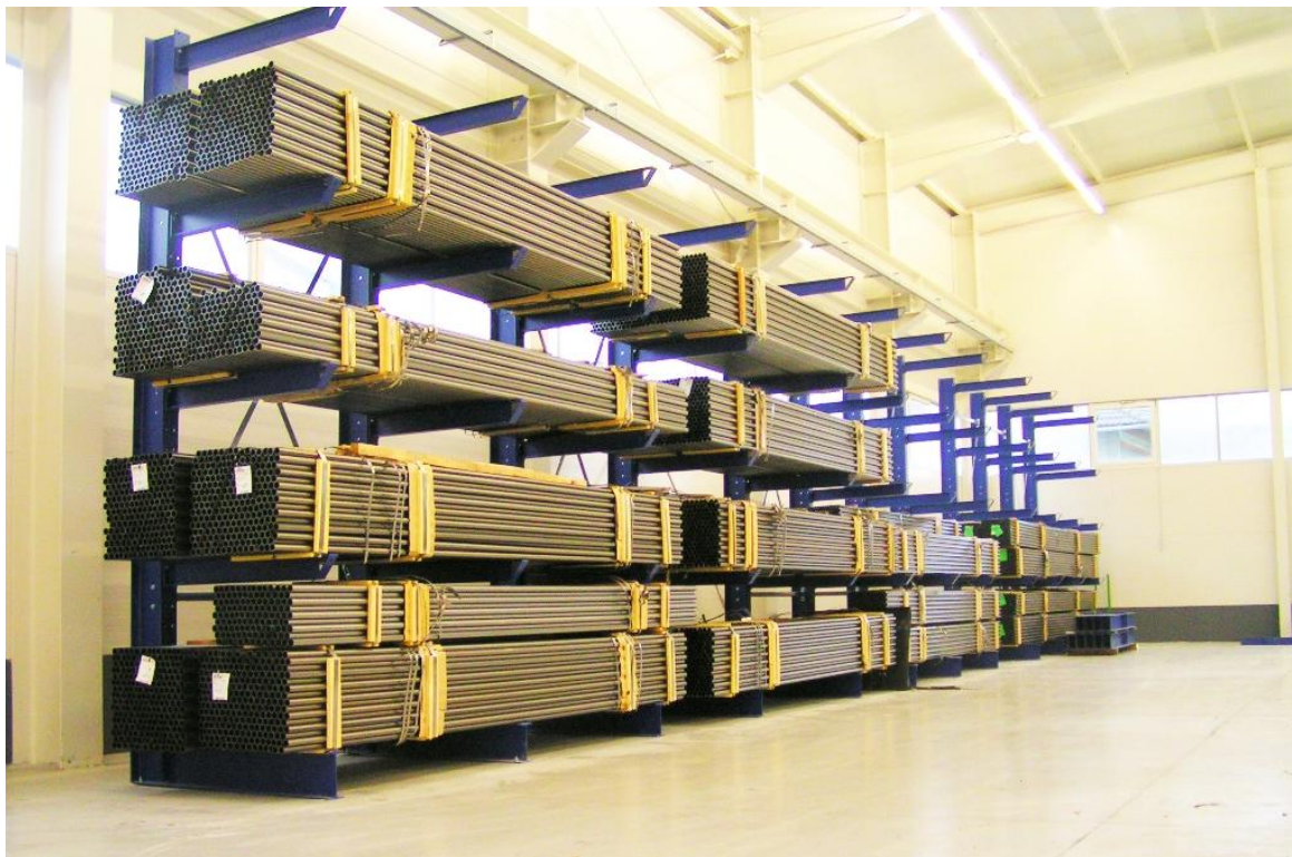
Slika 7. Skladište s konzolnim regalima
