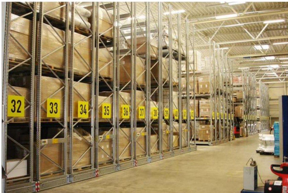
Slika 8. Skladište s prijevoznim paletnim regalima
