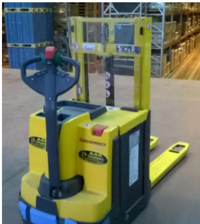
Slika 30. Niski električni viličar Jungheinrich
