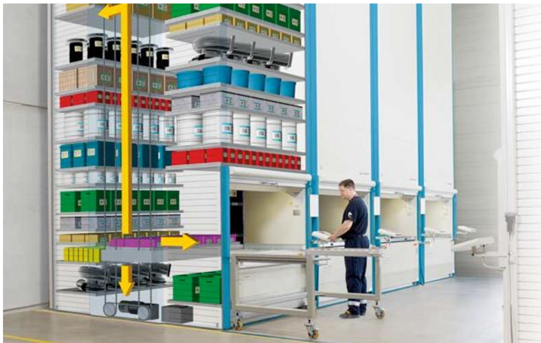
Slika 13. Sustav s 4 vertikalna podizna modula
