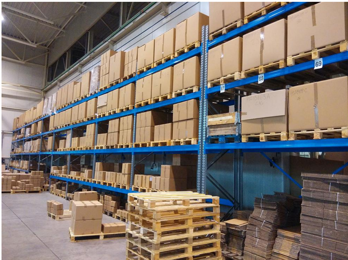
Slika 2. Klasična izvedba skladišta s paletnim regalima
