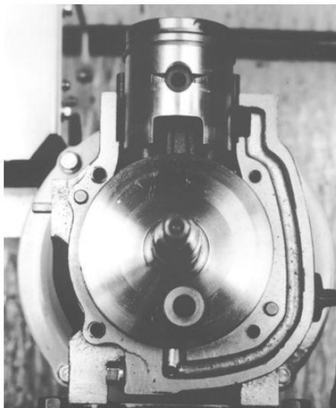
Slika 1. Poprečni presjek 2-taktnog ATAC motora [1]
