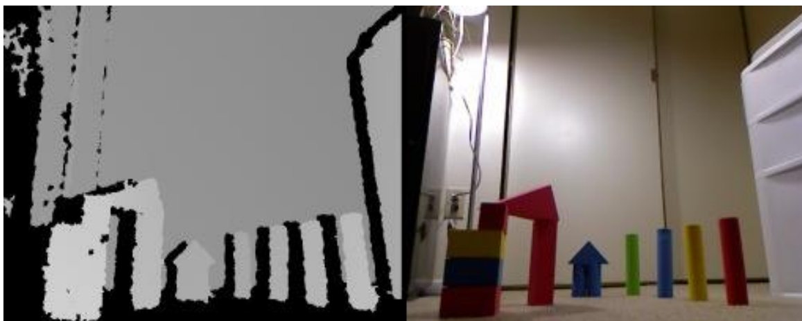
Slika 2.3: Slika dobivena dubinskom kamerom Kinect-a (lijevo) i slika dobivena RGB kamerom (desno)
