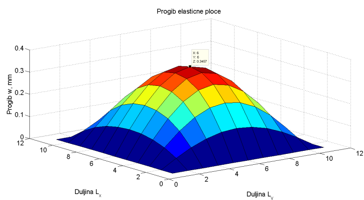
Slika 4.11: Progib: w = 0,345653 mm (100 elemenata)
