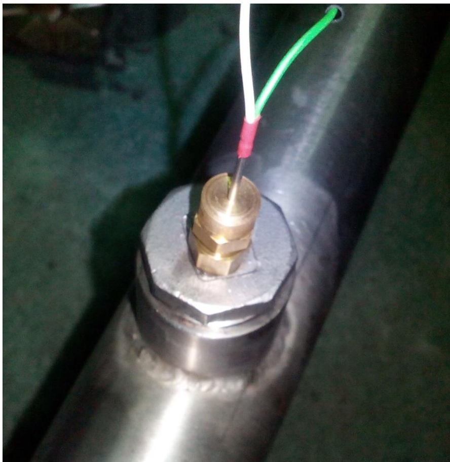
Slika 4.5. Prikaz spojenog termopara na cijevi.
