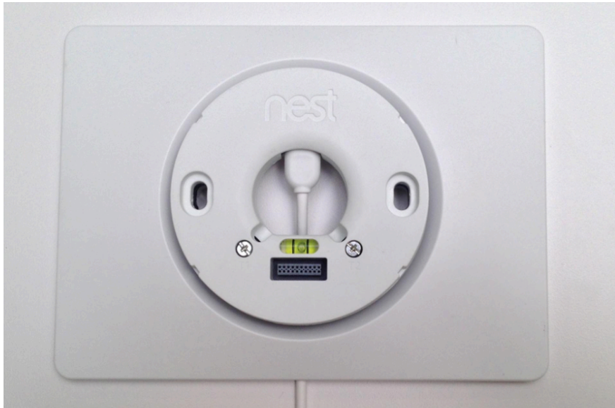
Slika 19. Bežična opcija spajanja Nest sobnog termostata (Nest se napaja pomoću USB kabla koji je uključen u utičnicu)
