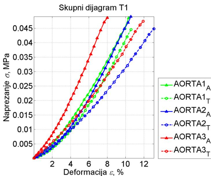
**Slika 65.** Dijagrami opterećenja uzoraka AORTA 1, AORTA 2 i AORTA 3 u aksijalnom (A) i transverzalnom (T) smjeru
