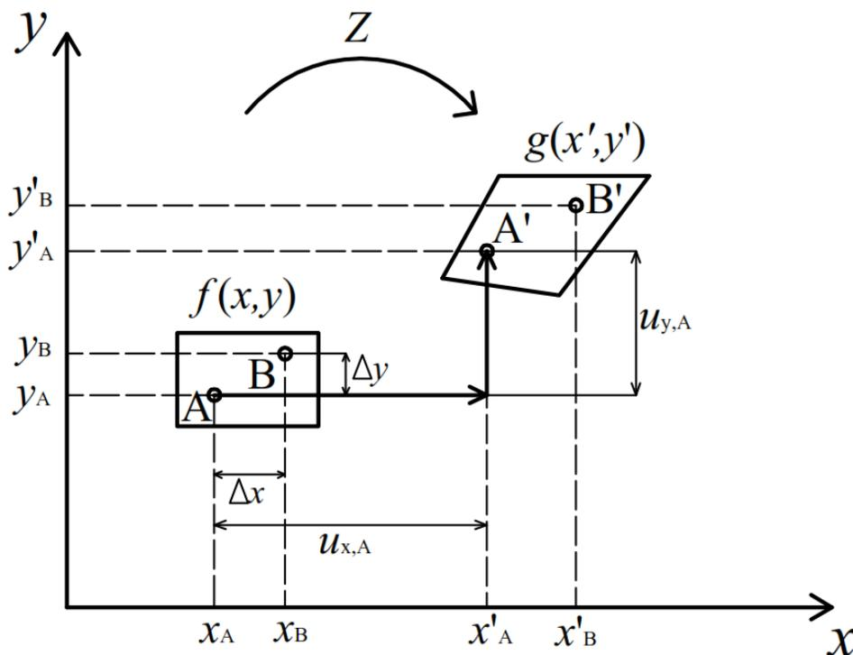
Slika 19. Referentna i deformirana konfiguracija
