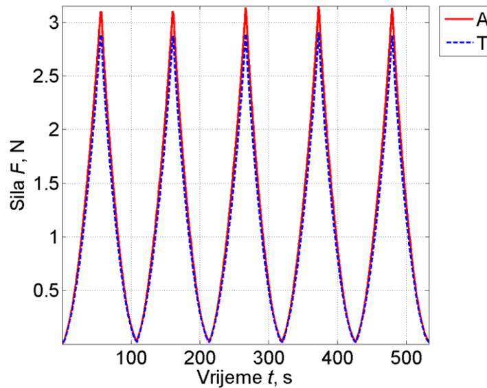
Slika 88. Dijagram promjene sile  $F$  za *Prekondicioniranje 2* uzorka AORTA 2 u aksijalnom (A) i transverzalnom (T) smjeru
