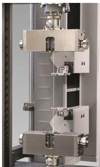
Slika 10. Mjerenje „sensor arm“ ekstenzometrom [48]
