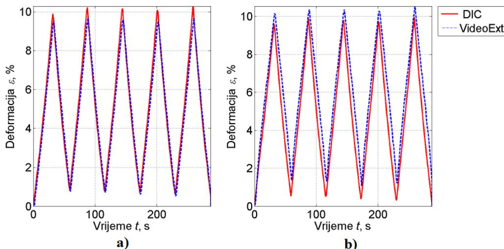
**Slika 43.** Usporedni prikaz promjene deformacije  $\varepsilon$  u vremenu  $t$  za *Prekondicioniranje 1* uzorka AORTA 1 u a) aksijalnom (A) i b) transverzalnom (T) smjeru za DIC i videoekstenzometar
