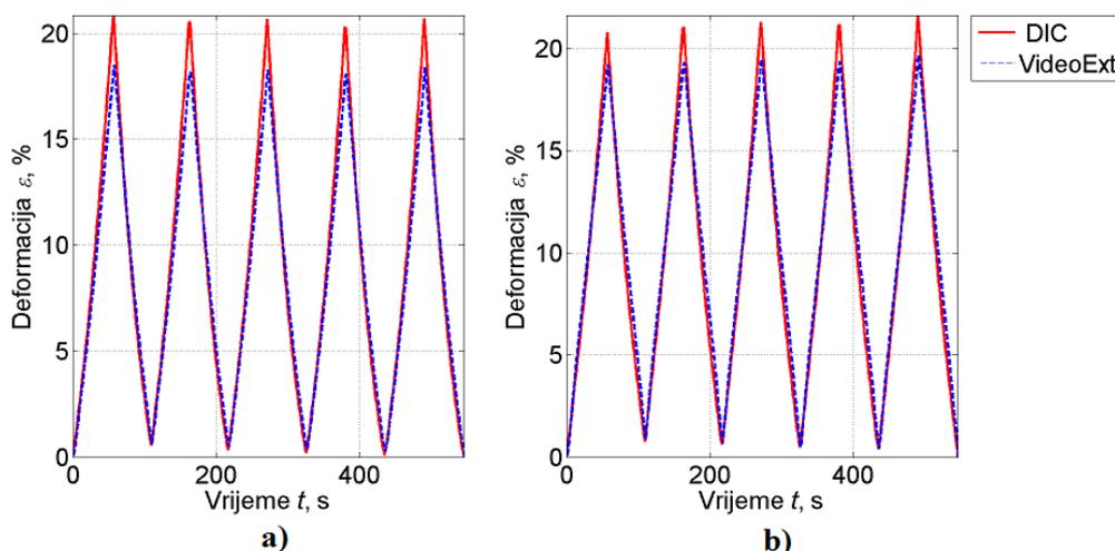
**Slika 54. Usporedni prikaz promjene deformacije  $\varepsilon$  u vremenu  $t$  za *Prekondicioniranje 2* uzorka AORTA 1 u a) aksijalnom (A) i b) transverzalnom (T) smjeru za DIC i videoekstenzometar**
