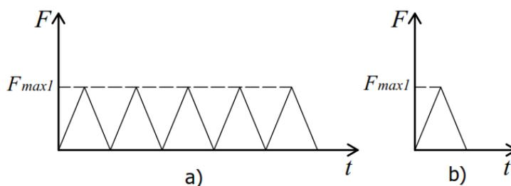
**Slika 39.** a) *Prekondicioniranje 1*, b) *Test 1*
