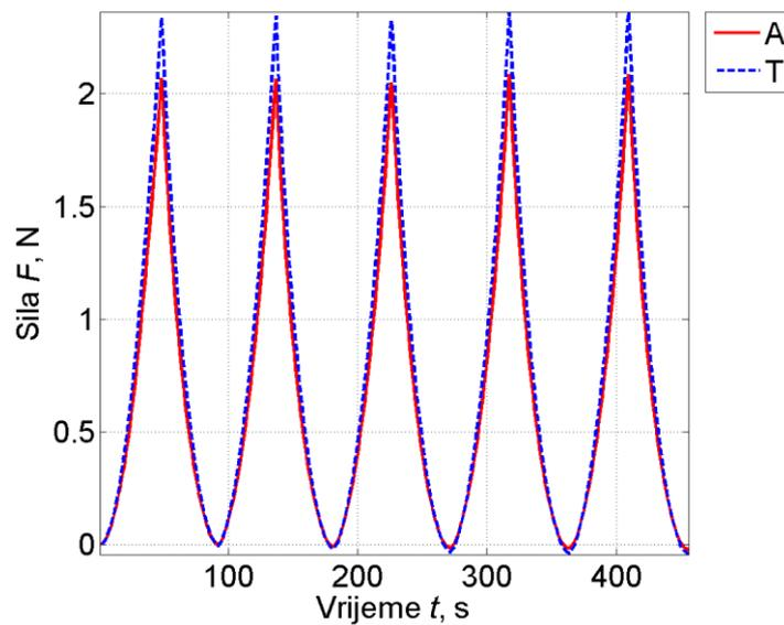
Slika 128. Dijagram promjene sile  $F$  za *Prekondicioniranje 2* uzorka AORTA 4 u aksijalnom (A) i transverzalnom (T) smjeru
