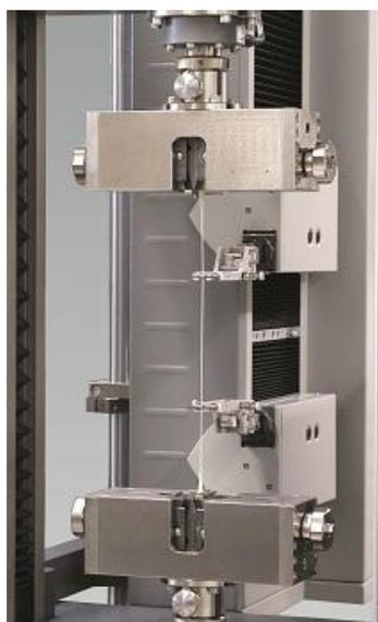
Slika 10. Mjerenje „sensor arm“ ekstenzometrom [48]
