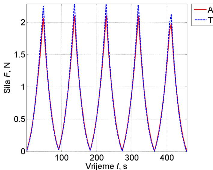
Slika 108. Dijagram promjene sile  $F$  za *Prekondicioniranje 2* uzorka AORTA 3 u aksijalnom (A) i transverzalnom (T) smjeru
